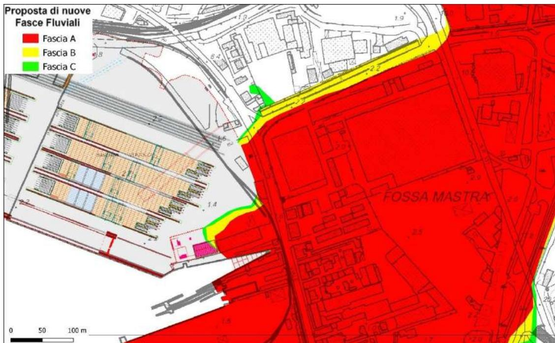
**Figura 7-1 – Proposta di nuova perimetrazione delle fasce fluviali – stato di progetto.**
