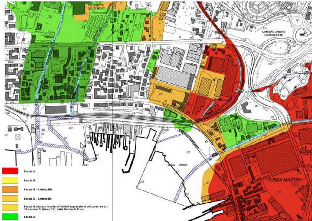
Figura 6 - Fasce di pericolosità idraulica da Piano di Bacino vigente (dettaglio area di intervento): Rio Melara, Canale Fossamastra, torrente Vecchia Dorgia.
