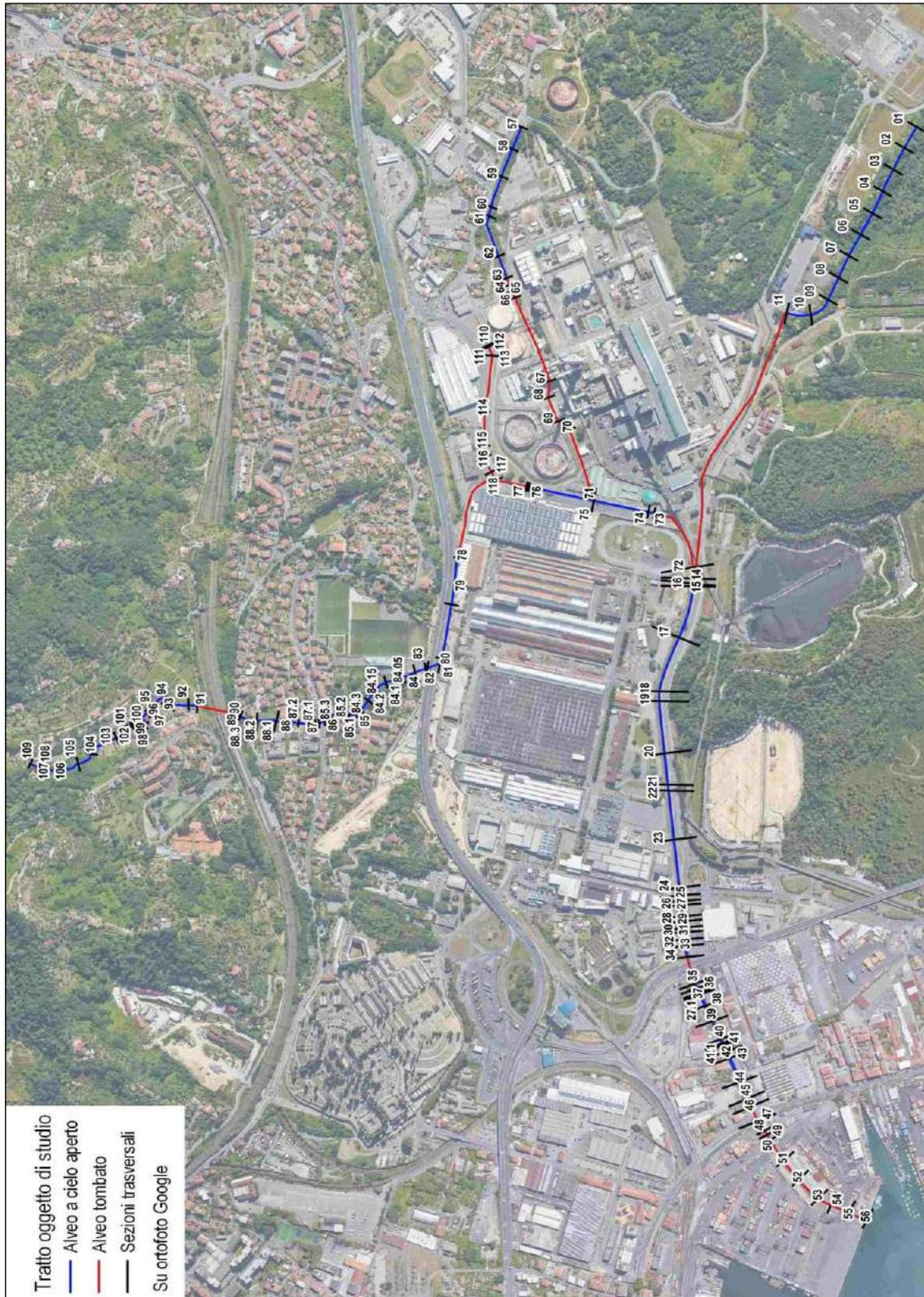
Figura 5-7 - Network del modello progressivo MIKE11 allestito per il sistema idrodinamico Fossamastra.
