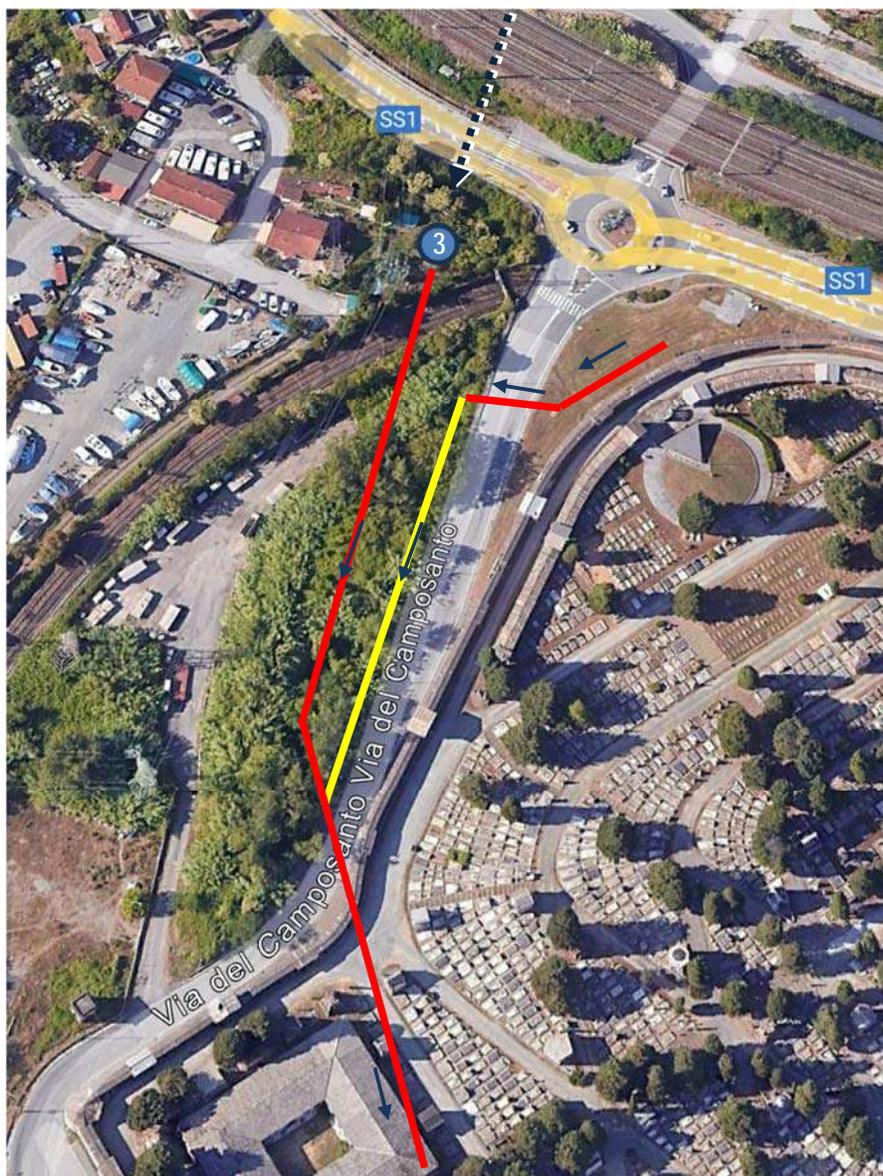
Figura 13 – Ricostruzione del tracciato più verosimile dell'alveo tombato del rio Melara. In giallo il tratto a cielo aperto a lato di Via del Camposanto.
