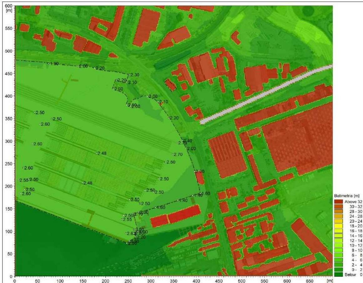
**Figura 5-22 - Ingrandimento nell'area di interesse della batimetria dello scenario di progetto del modello 2D del sistema idrodinamico del canale Fossamastra a maglia 2,0x2,0 m.**
