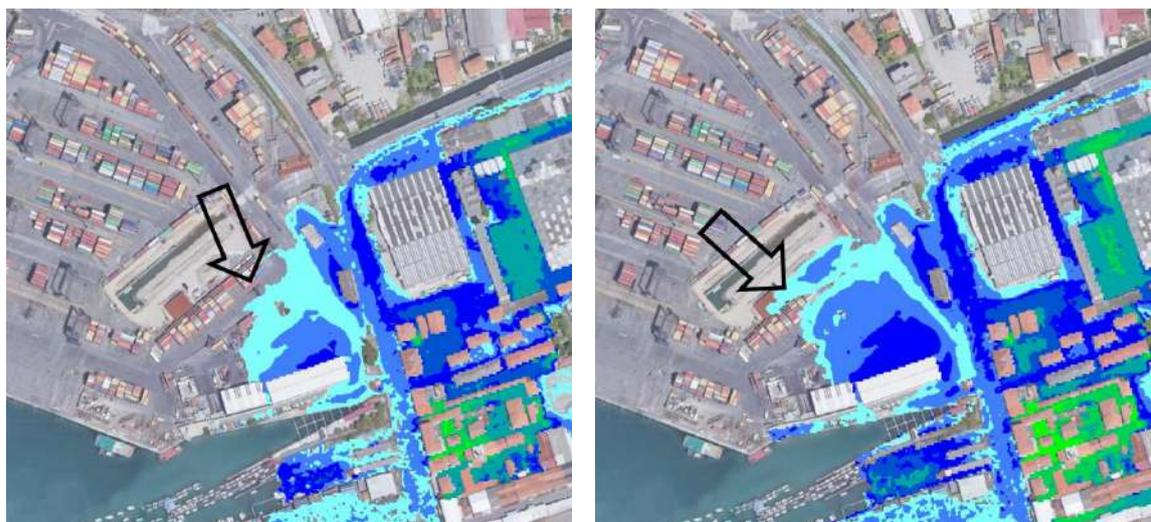
**Figura 5-18 -Stato attuale - Distribuzione inviluppo delle massime altezze idriche rispetto al piano campagna per TR=50 anni (sx) e TR=200 anni (dx).**
