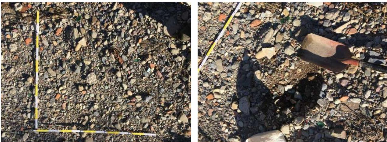
Figura 9 – Sito di campionamento presso il Fosso Tassonaro (bacino "Lagora 2"). A destra risulta visibile l'effetto di corazzamento superficiale ad opera di clasti di maggiori dimensioni.
