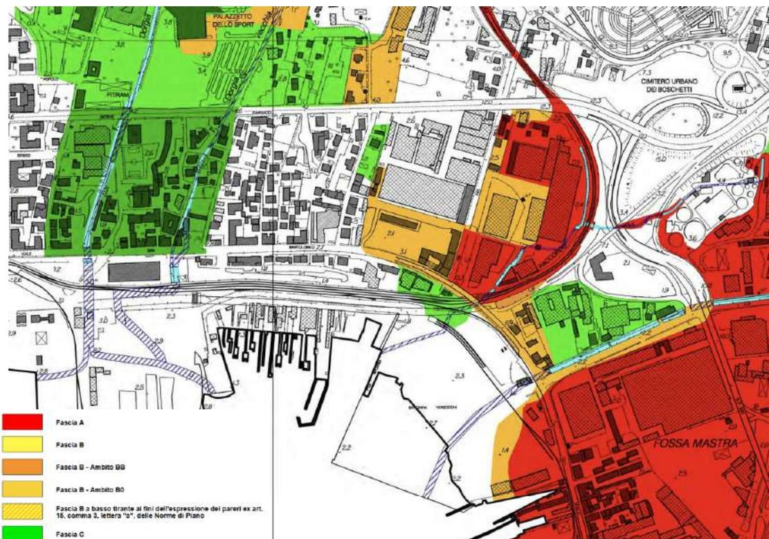
**Figura 3 - Fasce di pericolosità idraulica da Piano di Bacino vigente (dettaglio area di intervento): Rio Melara, Canale Fossamastra, torrente Vecchia Dorgia.**
