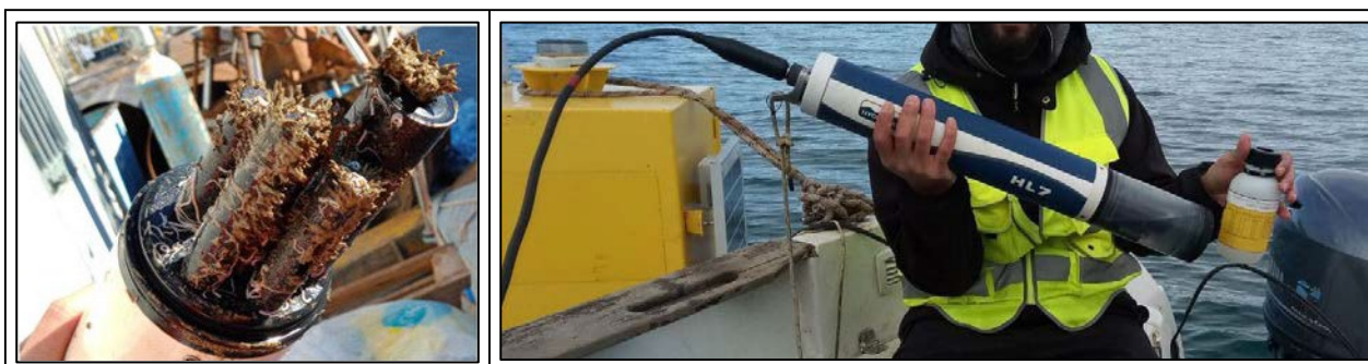
Figura 14 - Accumulo di biofouling su sonda operata nel Golfo e calibrazione di una HL7 con fluido certificato.
