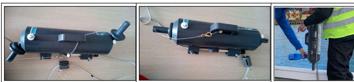
Figura 8 - Stato aperto e chiuso del campionatore d'acqua bottiglia Niskin, e utilizzo in campo.
