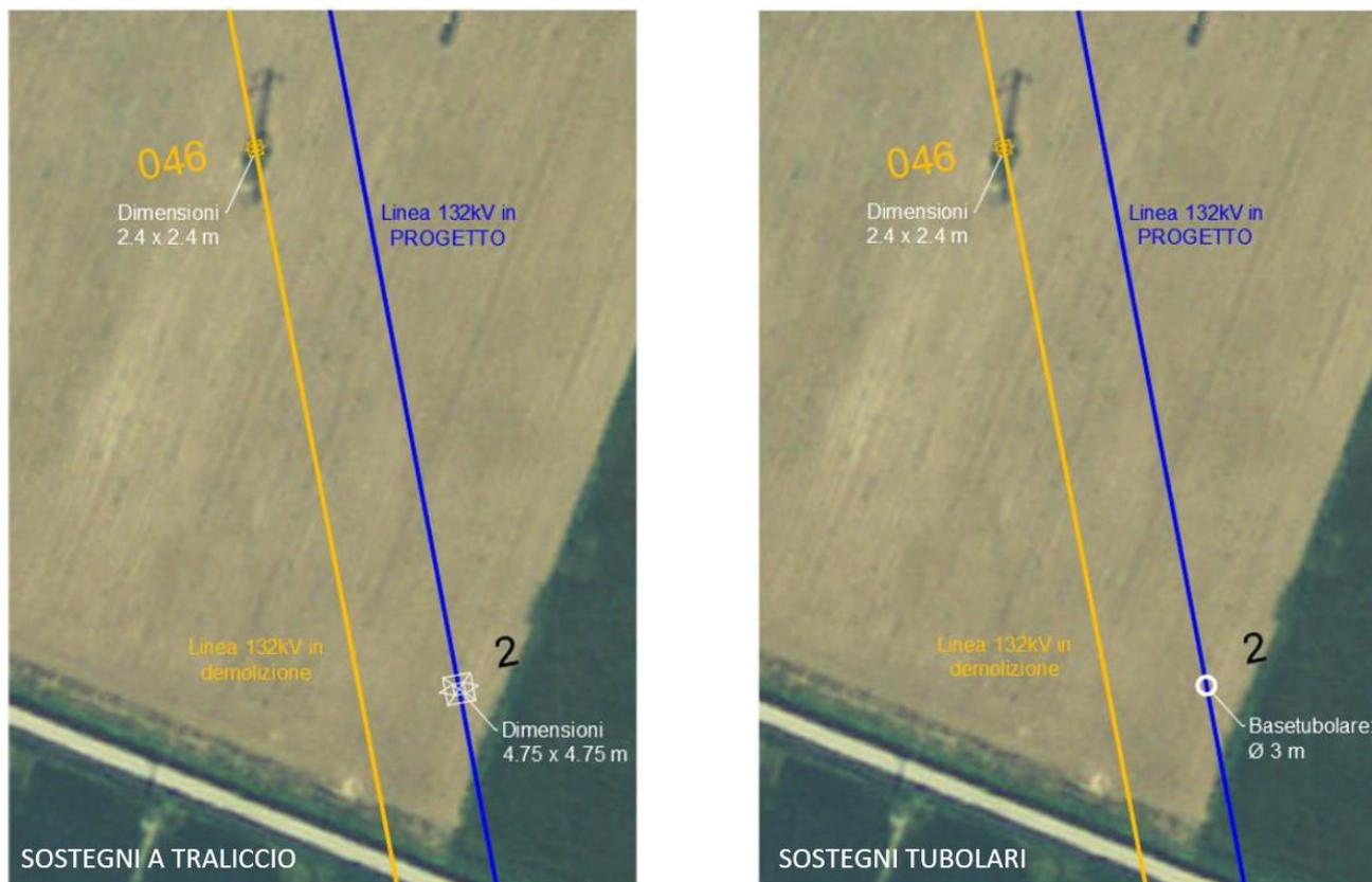
**Figura 6.7:** confronto ingombro al suolo di sostegni esistenti in demolizione, sostegni a traliccio previsti in PTO e sostegni tubolari
