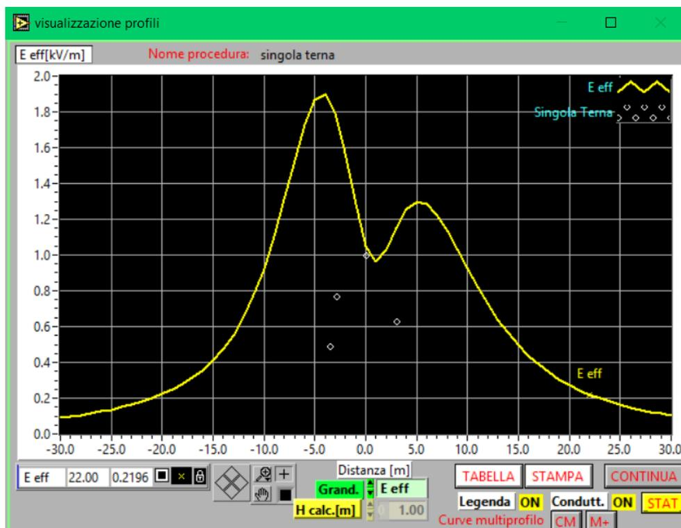
Figura 10 - Configurazione 1A (singola terna) Campo elettrico espresso in kV/m (valori efficaci) a 1 m dal suolo
