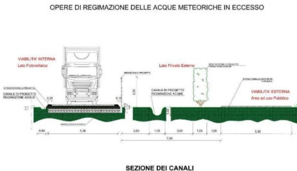
Figura 13. Opere di regimazione delle acque meteoriche in eccesso
