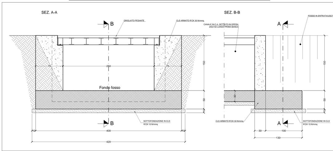
POZZETTO V<sub>s12</sub> - Scala 1:50
