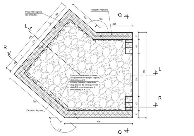
Pozzetto di uscita Vv- Sezione S-S
