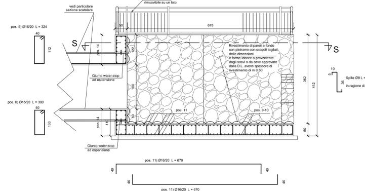
Pozzetto di uscita Vv- Sezione R-R
