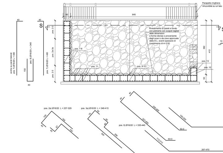
Pozzetto di uscita Vv- carpenteria
