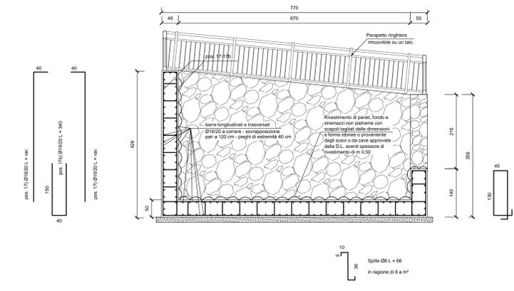
Pozzetto di uscita Vv- Sezione L-L
