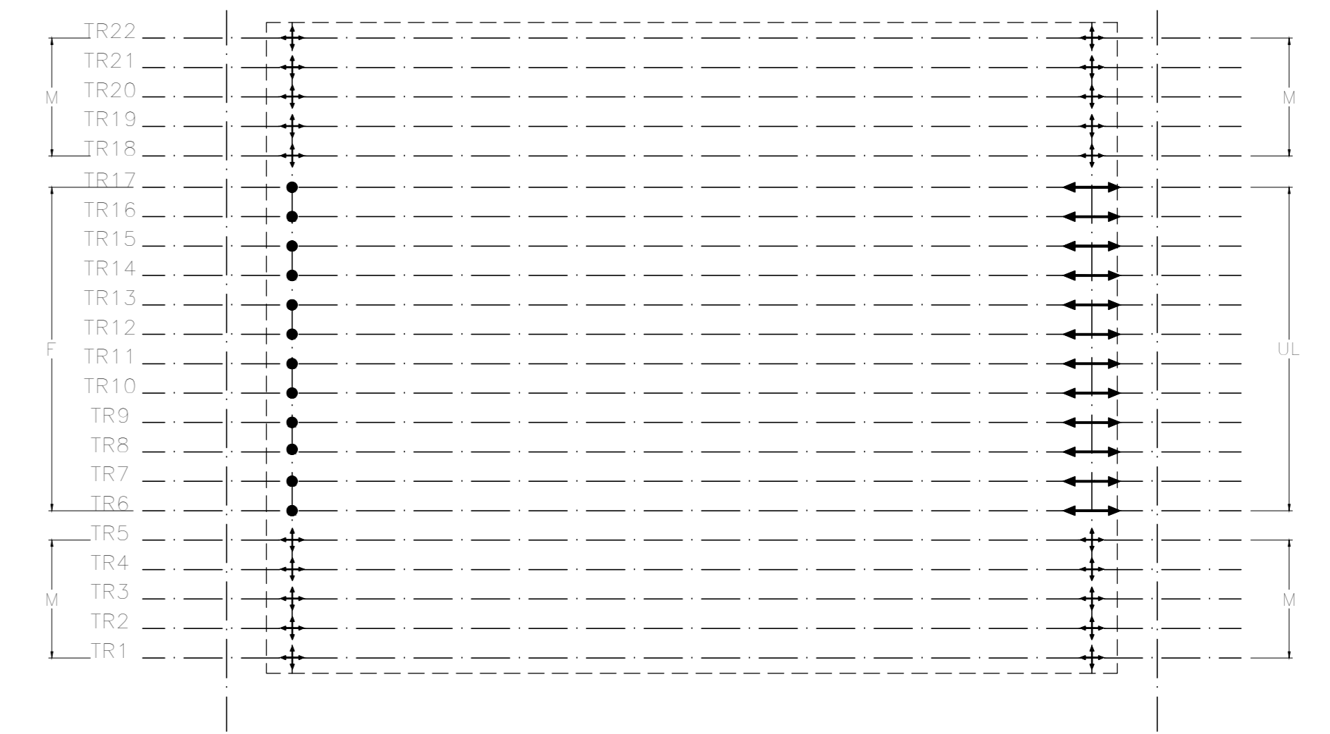
CAMPATA A TRAVI INCORPORATE 22m
