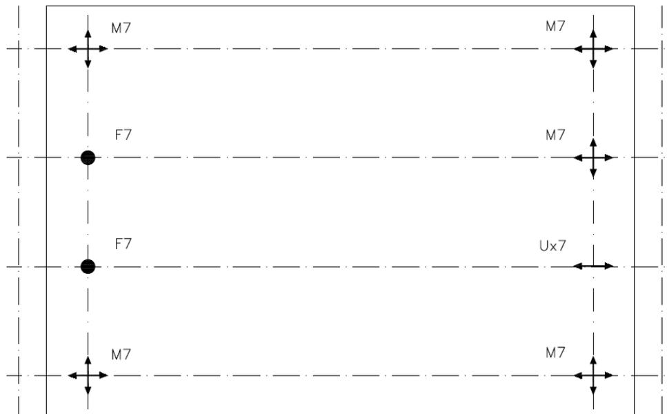
Figura 4 – Schema appoggi
