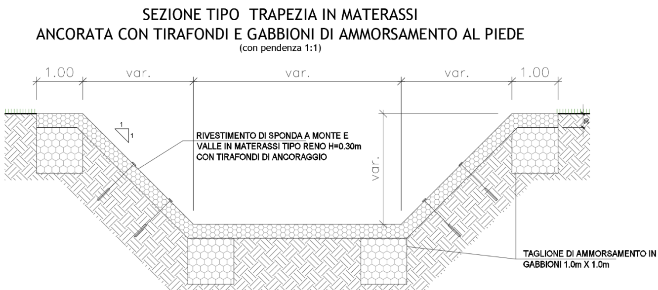
Figura 5.1: Sezione tipologica del rivestimento di una deviazione di un canale avente sponde con pendenza > 40°
