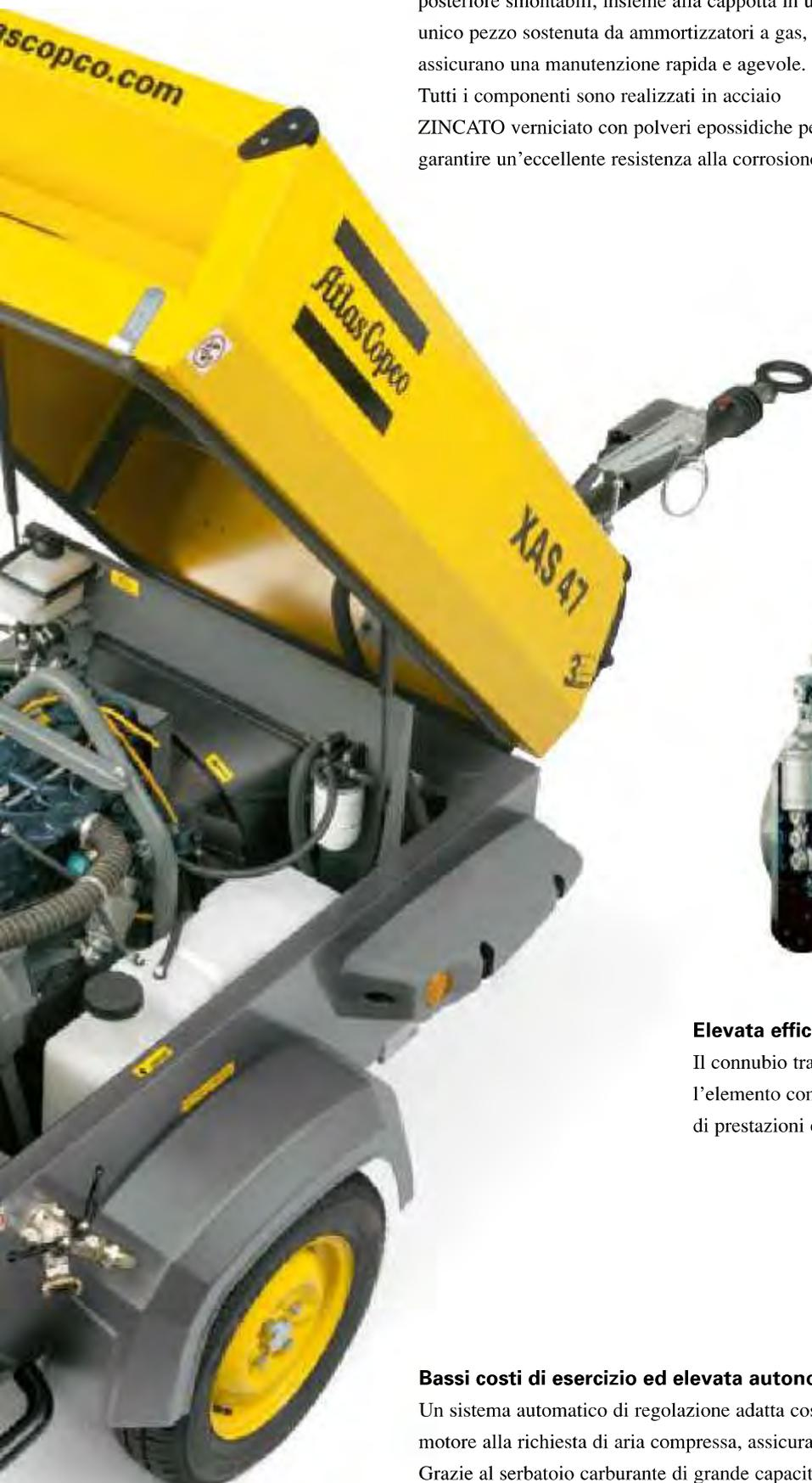
Motore Deutz 2011 montato sui modelli XA(T,H)S 37-97 Dd
