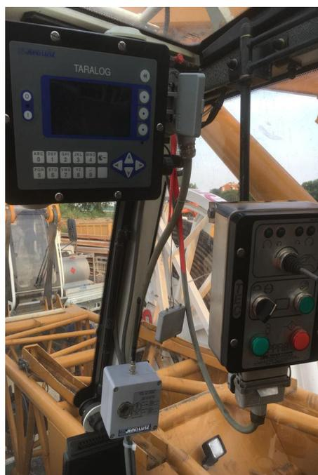
Figura 4 Sistema di controllo benna
