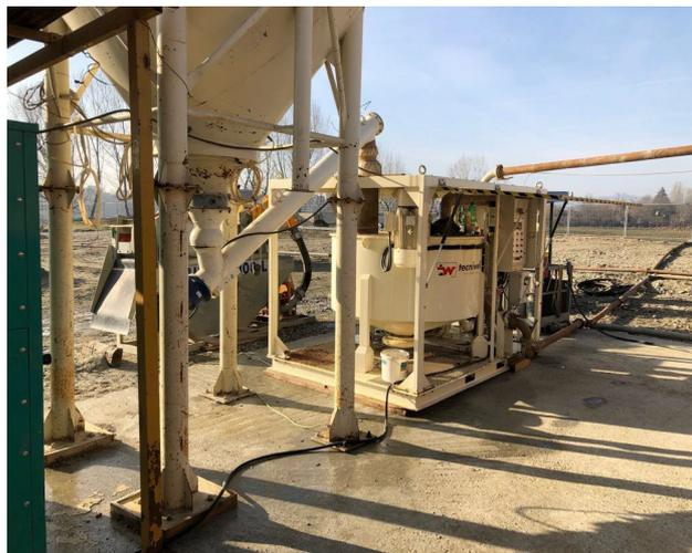
*Figura 7 Impianto di miscelazione acqua/bentonite o polimero (impianto e gestione dei fanghi) TECNIWELL TW 2000*
