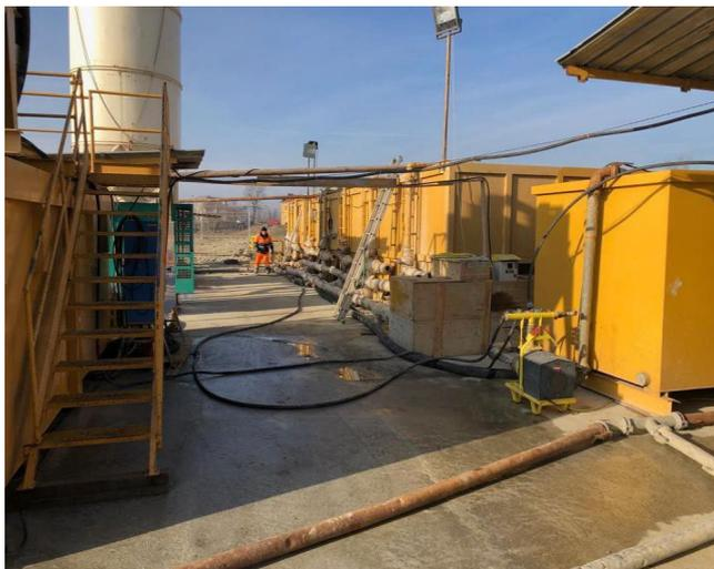
*Figura 6 Vasche di stoccaggio fanghi*
