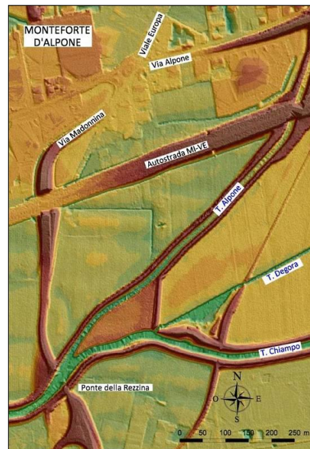
Fig. 4.2 - Particolari della rappresentazione a scala di colori ed a luci e ombre dei dati altimetrici originali rilevati in volo con la tecnica laser-scanner (LIDAR) nella zona della confluenza Tramigna-Alpone, nell'abitato di Soave e nella zona della confluenza Chiampo-Alpone.
