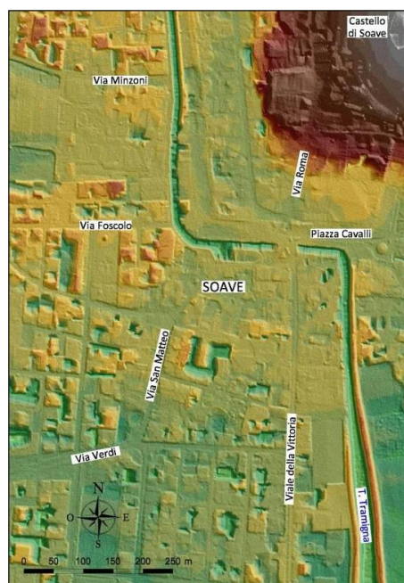
Fig. 4.2 - Particolari della rappresentazione a scala di colori ed a luci e ombre dei dati altimetrici originali rilevati in volo con la tecnica laser-scanner (LIDAR) nella zona della confluenza Tramigna-Alpone, nell'abitato di Soave e nella zona della confluenza Chiampo-Alpone.
