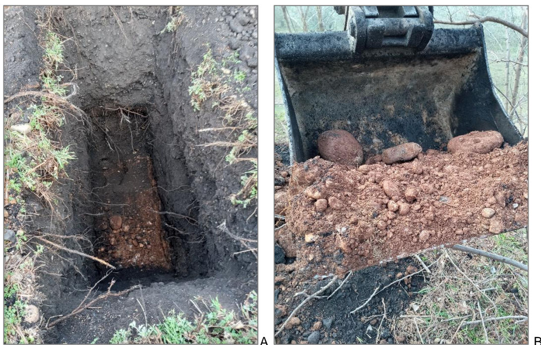
Figura 7 – Punto di Indagine SC02_T10. (A) Sul fondo dello scavo si rinvencono i materiali dei depositi naturali in posto, che sono preceduti da circa 2,5 m di materiale alloctono scuro. (B) Ghiaie in matrice sabbioso limosa rossastra rinvenute sul fondo scavo, che rappresentano il terreno naturale presente nell'area di indagine.
