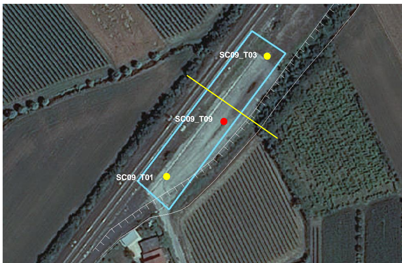
Figura 1 – Limite dell'area SC09 (perimetro azzurro) e lineamenti della scarpata del rilevato su cui ha sede la piazzola ferroviaria. Il circolo rosso indica l'ubicazione del sondaggio R57bis (Progetto Definitivo) e della trincea esplorativa SC09_T09 (Progetto Esecutivo). I circoli gialli indicano le altre due trincee realizzate in questa fase di progetto. La linea gialla indica la traccia della sezione considerata per il modello stratigrafico del sito.
