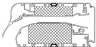
Figura 1 – Aeratore a ventilazione naturale
