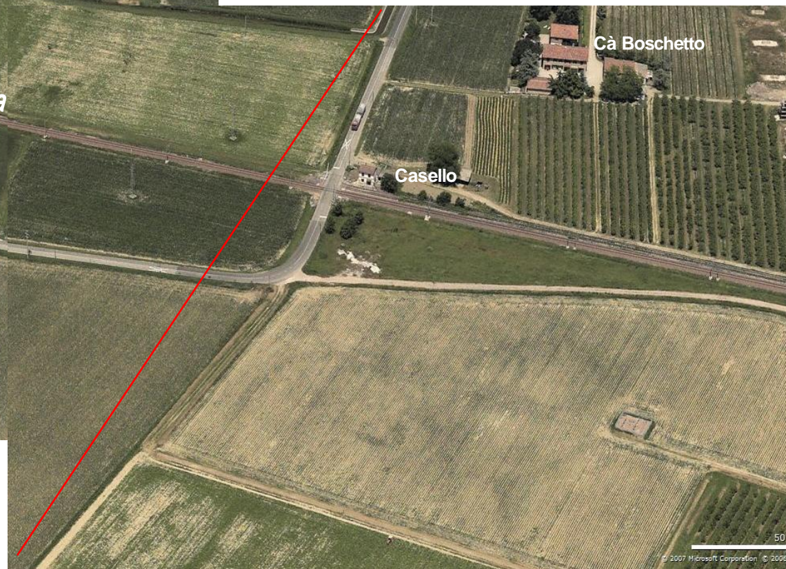
Vista panoramica del tracciato attuale a monte di via Arginone con ubicazione dei sostegni 16 e 17 della linea 132 kV n. 767, da demolire e tracciato di progetto (linea rossa); attraversamento della linea ferrata Ferrara – Suzzara e della via Catena, presso la località Casello.
