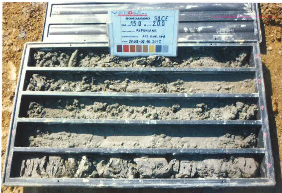
SONDAGGIO S1Ce: cassetta n. 4 da 15,00 m a 20,00 m
