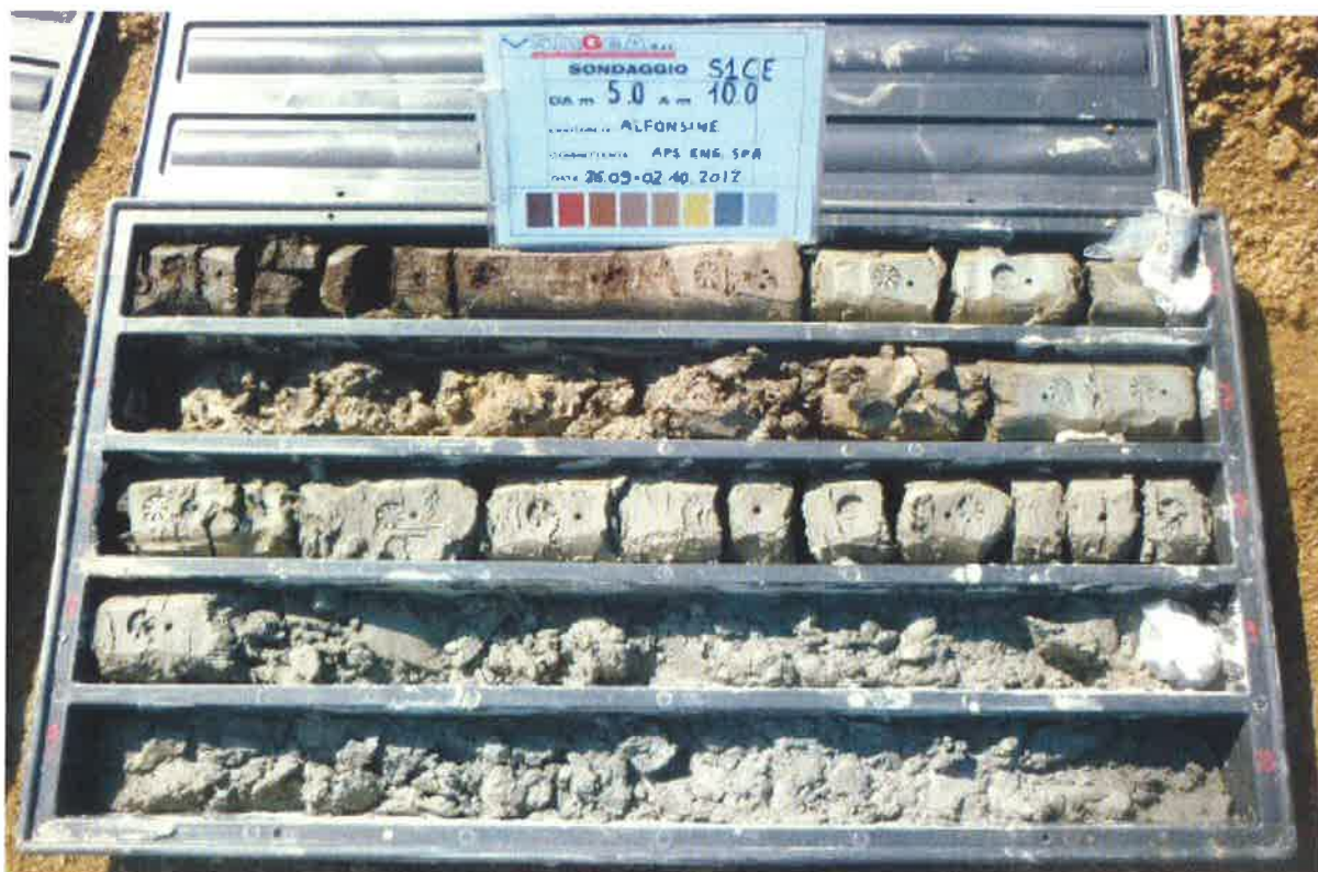
SONDAGGIO S1Ce: cassetta n. 2 da 5,00 m a 10,00 m
