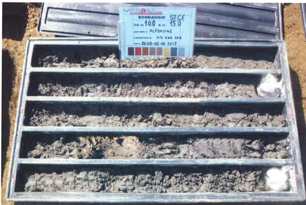
SONDAGGIO S2Ce: cassetta n. 3 da 10,00 m a 15,00 m
