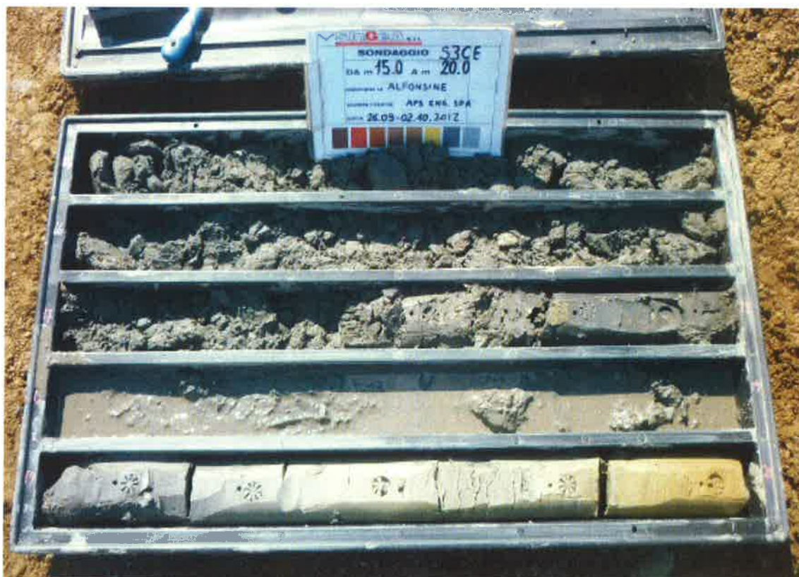
SONDAGGIO S3Ce: cassetta n. 4 da 15,00 m a 20,00 m
