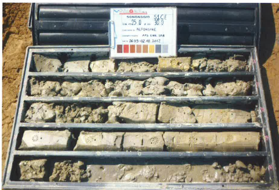
SONDAGGIO S1Ce: cassetta n. 6 da 25,00 m a 30,00 m
