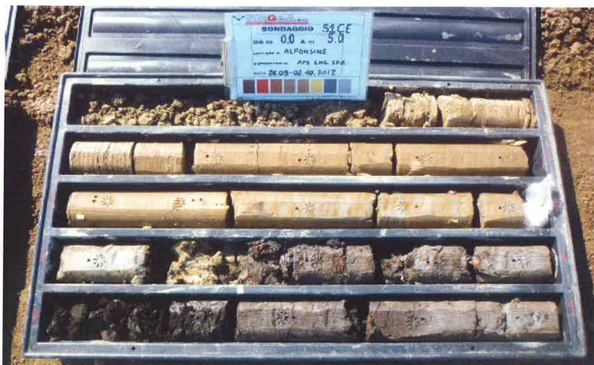
SONDAGGIO S1Ce: cassetta n. 1 da 0,00 m a 5,00 m
