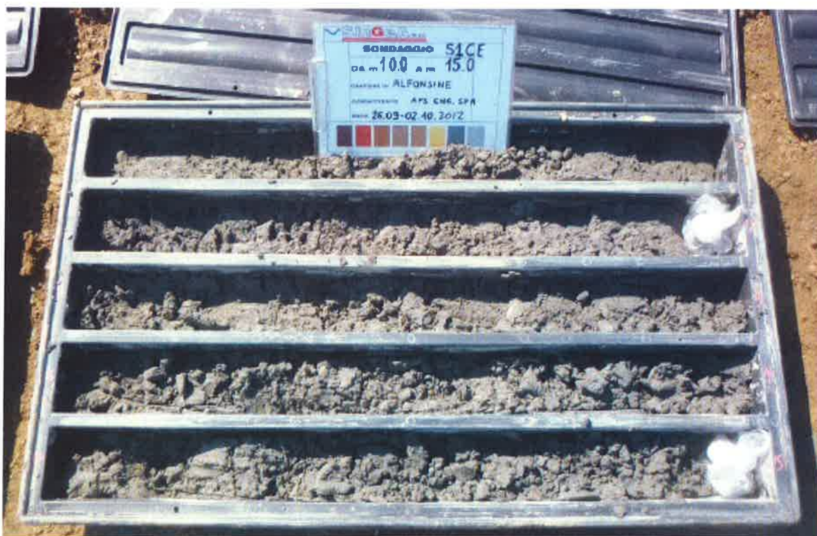
SONDAGGIO S1Ce: cassetta n. 3 da 10,00 m a 15,00 m
