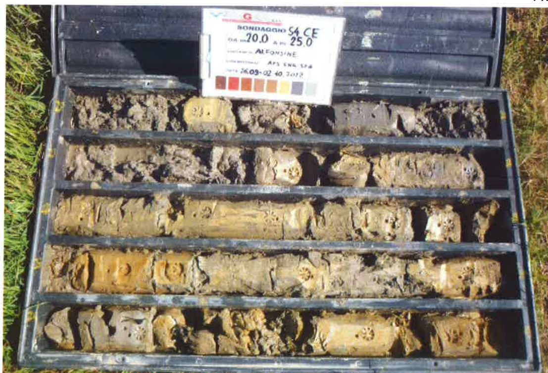
SONDAGGIO S4Ce: cassetta n. 5 da 20,00 m a 25,00 m
