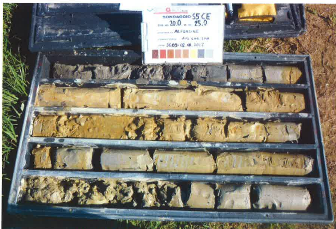
SONDAGGIO S5Ce: cassetta n. 5 da 20,00 m a 25,00 m
