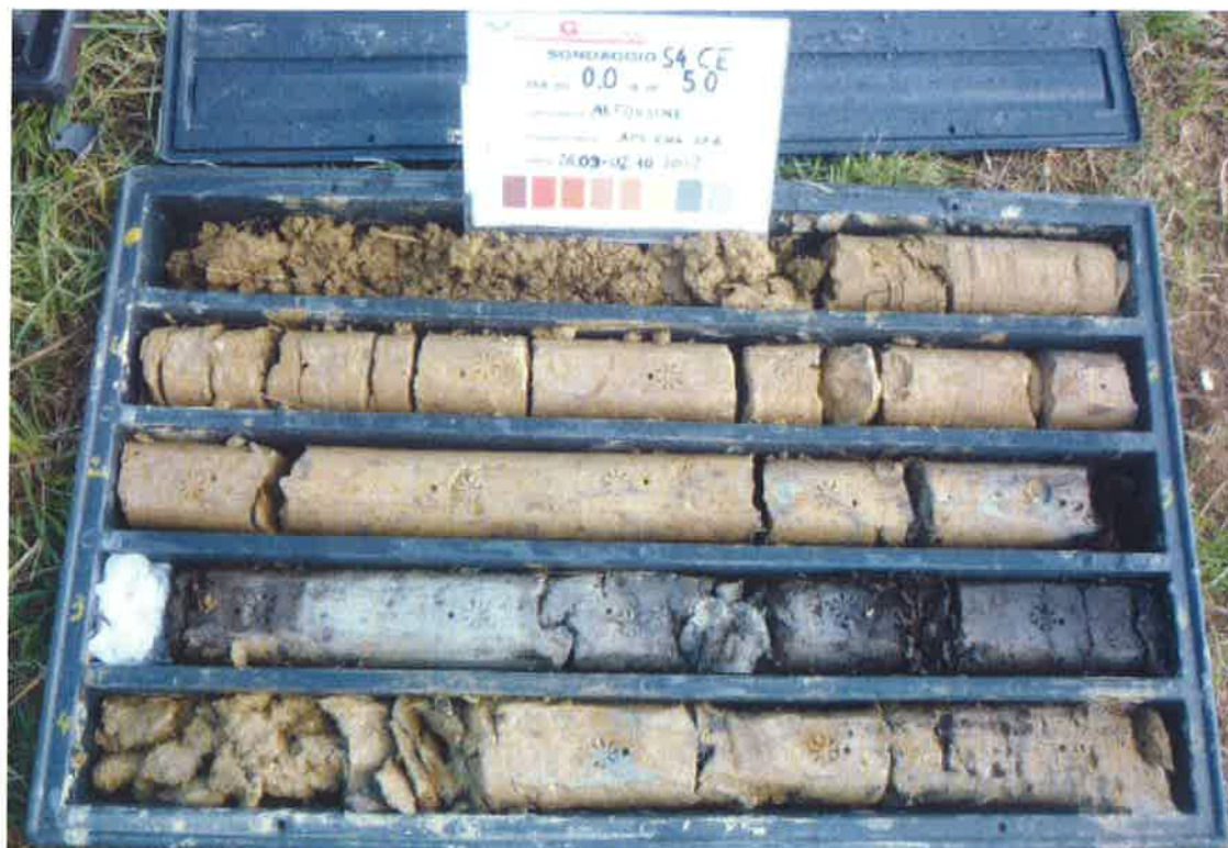
SONDAGGIO S4Ce: cassetta n. 1 da 0,00 m a 5,00 m
