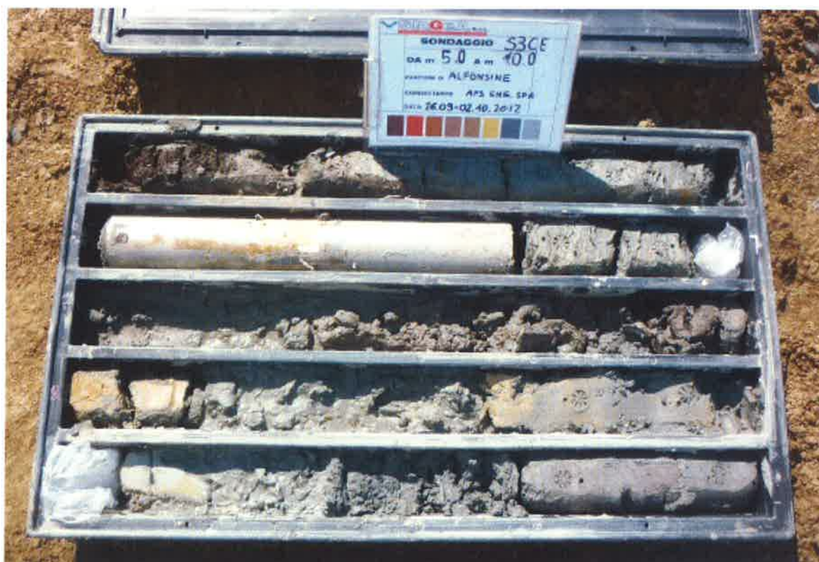
SONDAGGIO S3Ce: cassetta n. 2 da 5,00 m a 10,00 m
