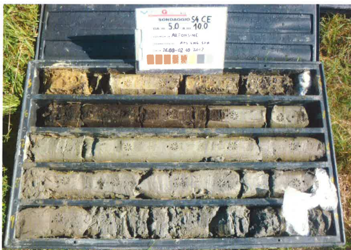
SONDAGGIO S4Ce: cassetta n. 2 da 5,00 m a 10,00 m
