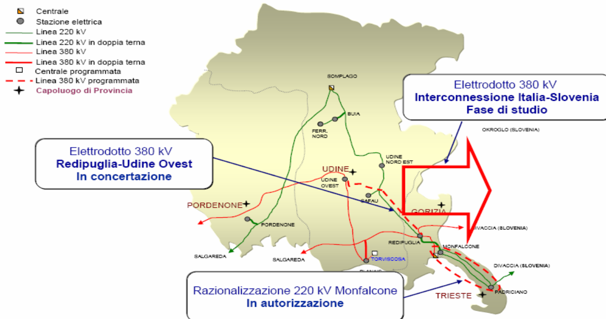
Fig. 9.16 – Rete elettrica regionale al 2008 [Fonte Terna 2008].
