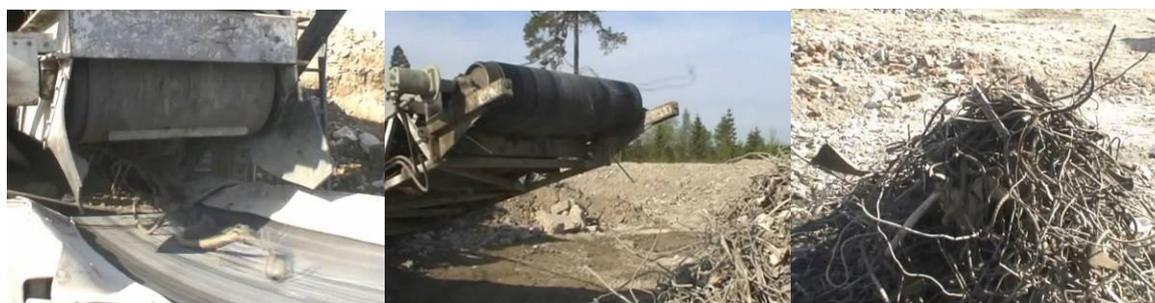
*Figura 6 –particolare del nastro trasportatore di recupero dell'acciaio di armatura da destinare al recupero in fchiere*
