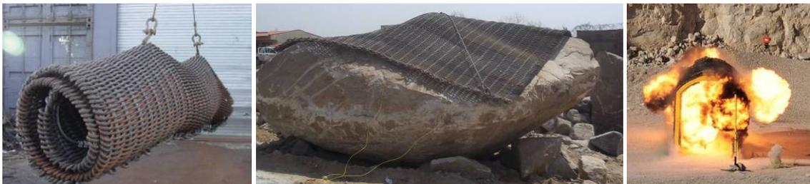
Figura 25 –Foto delle blasting shield e del loro funzionamento su campo
