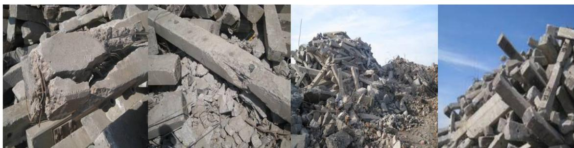
*Figura 3 –Rifiuti da demolizione di elementi strutturali in CLS armato*
