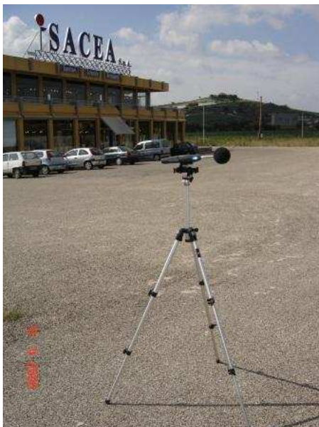
Posizionamento del fonometro presso il ricettore 44 e visuale sulla SS640
