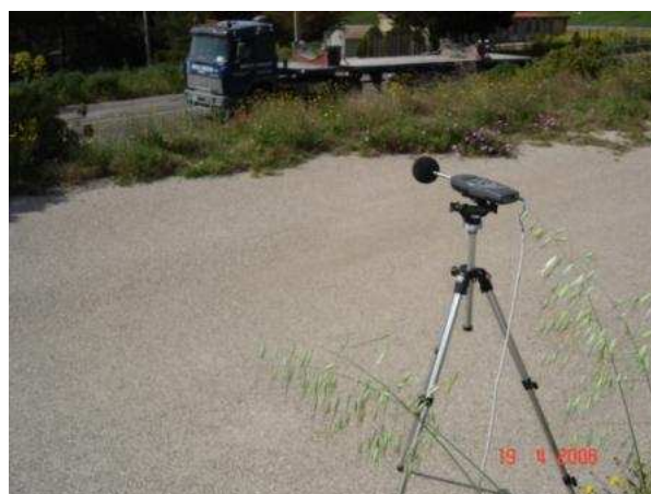
Posizionamento del fonometro presso il ricettore 75 e visuale sulla SS640
