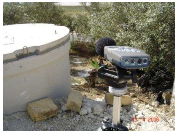
Posizionamento del fonometro presso il ricettore 22 e visuale sulla SS640
