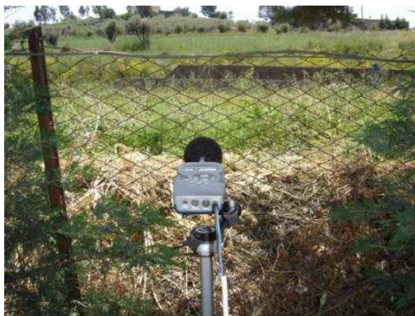
Posizionamento del fonometro presso il ricettore 300 e visuale sulla SS640
