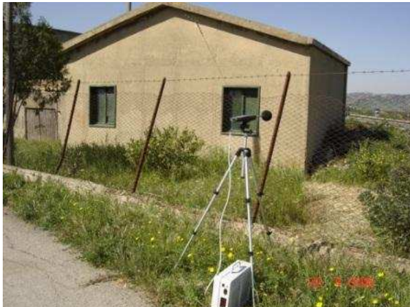
Posizionamento del fonometro presso il ricettore 305 e visuale sulla SS640
