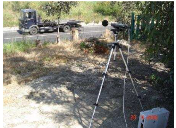
Posizionamento del fonometro presso il ricettore 342 e visuale sulla SS640
