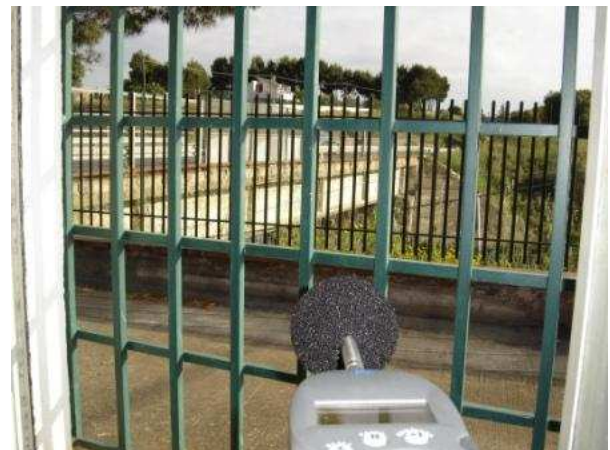
Posizionamento del fonometro presso il ricettore 224 e visuale sulla SS640
