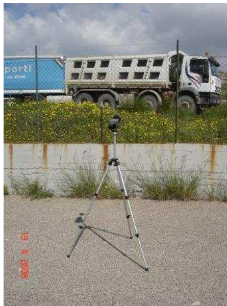
Posizionamento del fonometro presso il ricettore 44 e visuale sulla SS640
