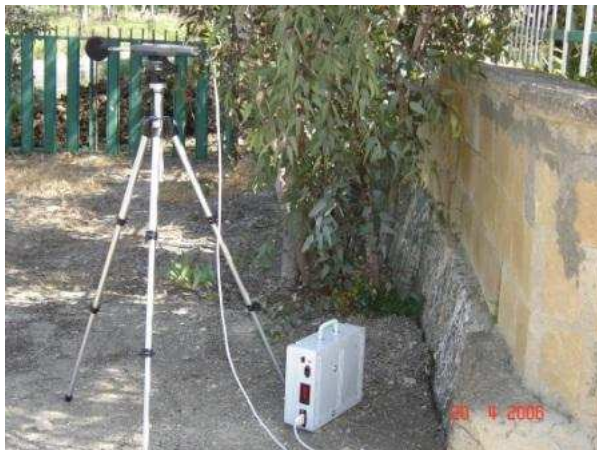
Posizionamento del fonometro presso il ricettore 342 e visuale sulla SS640
