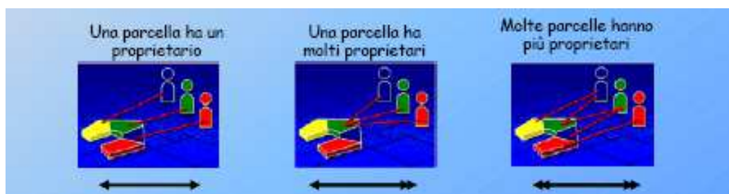
Fig. 6 – La figura illustra i tre tipi di cardinalità: a) 1 a 1, b) 1 a molti c) Molti a molti
