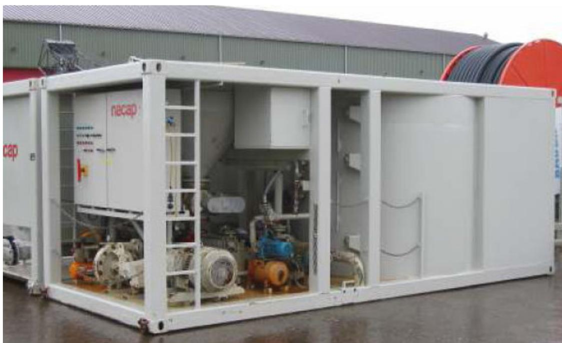
*Figura 4.13: unità di miscelazione fanghi*
