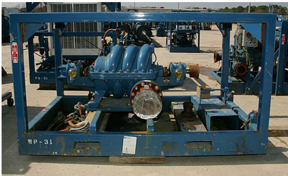
*Figura 4.21: esempio di pompa per il riempimento della condotta*
