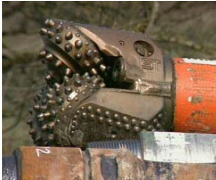
*Figura 4.17: scalpello per l'esecuzione del foro pilota*
