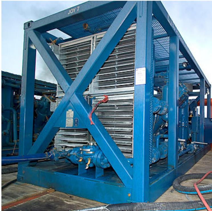
*Figura 4.22: esempio compressore da utilizzare per il dewatering*
