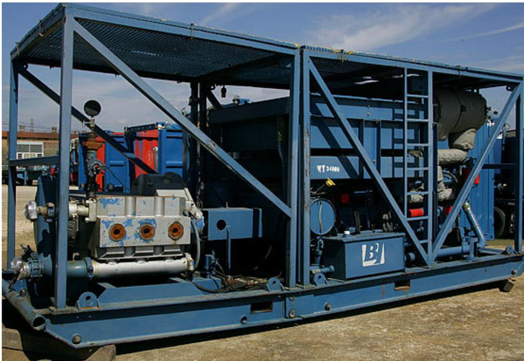
*Figura 4.22: esempio di pompa per la pressurizzazione*
