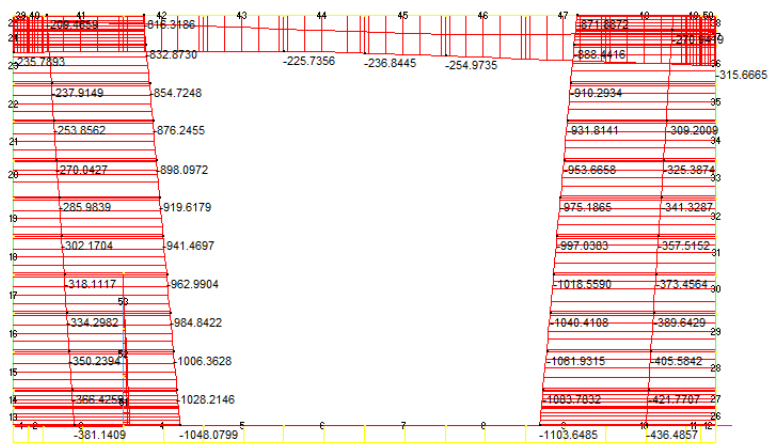
Figura 11 Involuppo SLU/Sisma: sforzo normale
