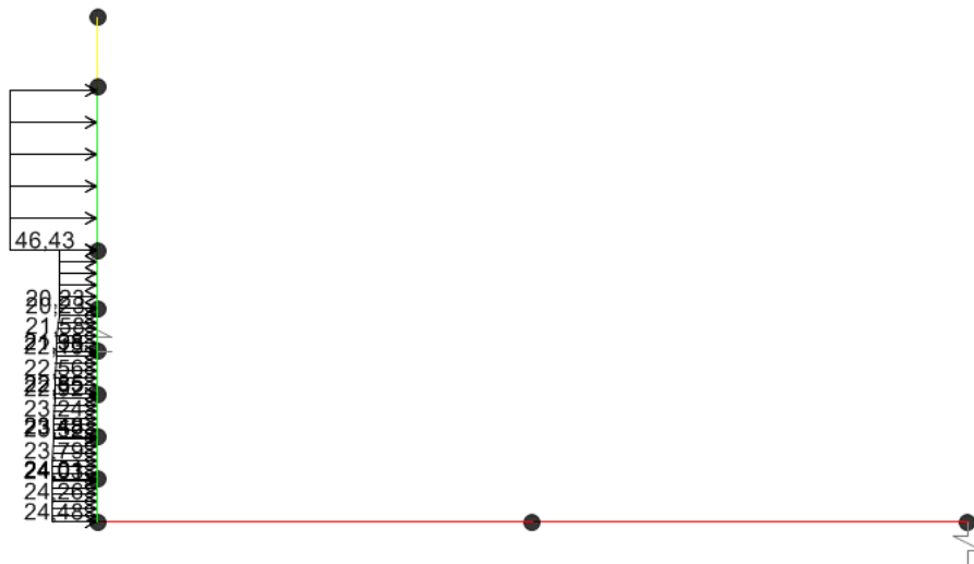
Figura 10-254 Load case 16 SPINTA SISMICA TERRE
