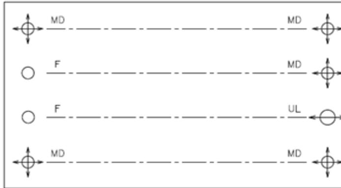
Figura 1 - Schema appoggi
