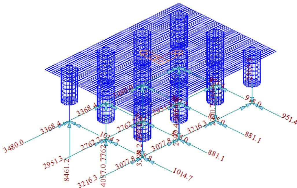
Figura 30 – Applicazione delle reazioni dei pali nel modello agli elementi finiti
