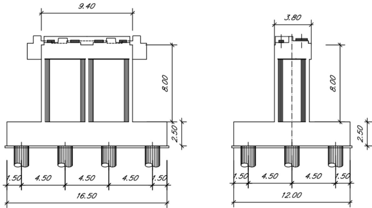
Figura 4 - Pianta e sezioni pila
