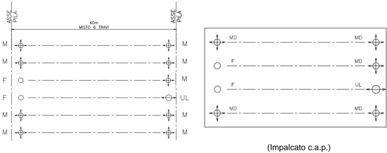
Figura 1 - Schema appoggi
