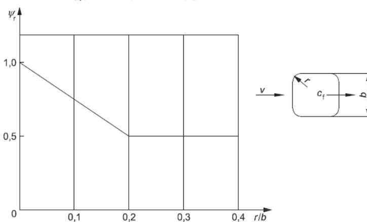
Figura 14 - correlazione tra il raggio di arrotondamento dello spigolo e il fattore riduttivo  $\psi_r$  (figura 7.24 EC1-4)
