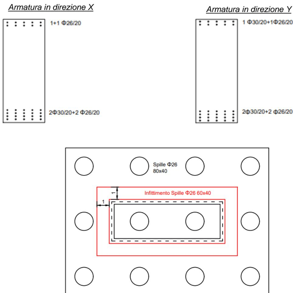
Figura 40 – Armatura a taglio del plinto
