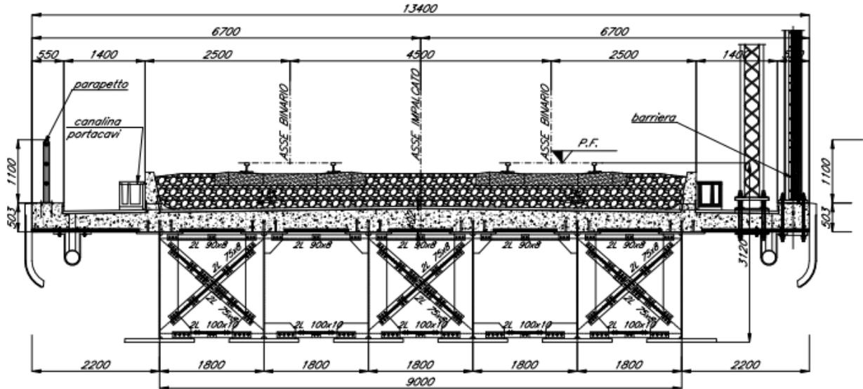
Figura 3 - Sezione impalcato misto 6 travi
