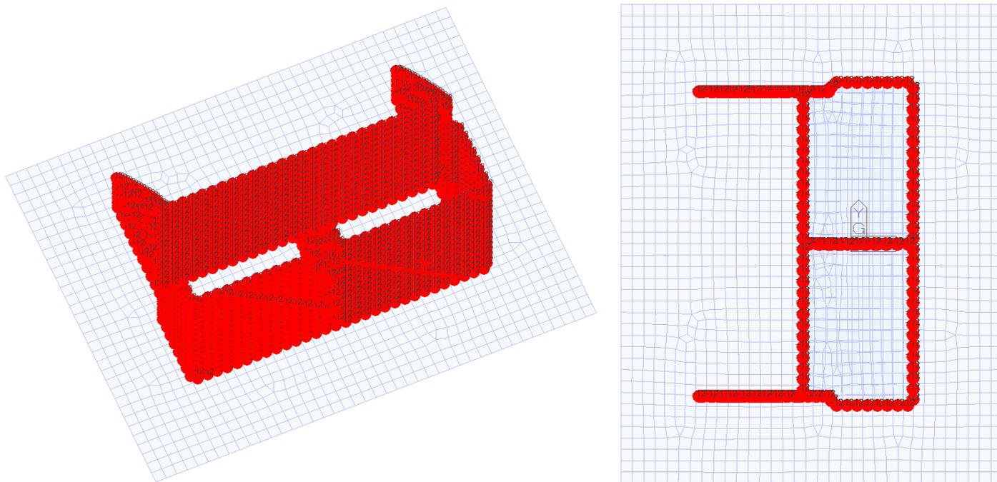
Figura 35: Applicazione del carico termico da ritiro sul modello FEM – Vista 3D - Vista in pianta
