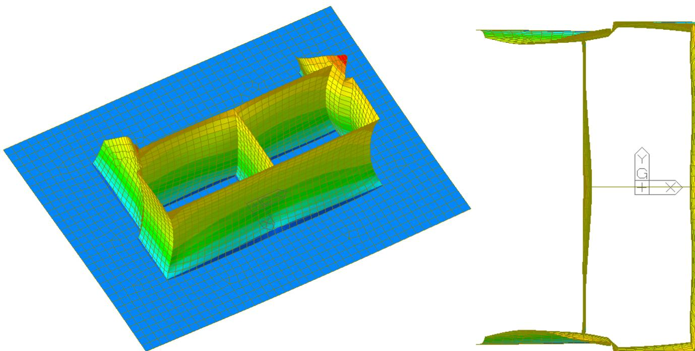
Figura 36: Deformata da ritiro differenziale fusto-fondazione – Vista 3D - Vista in pianta
