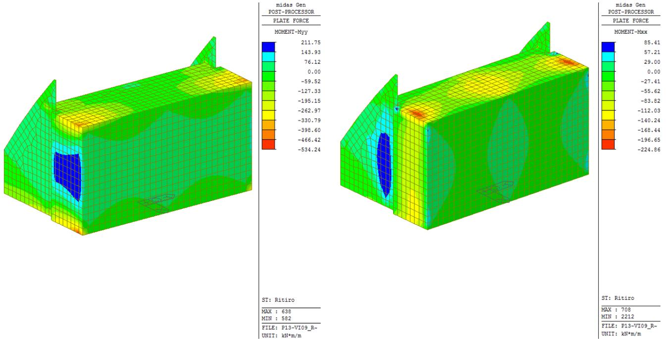
Figura 40: Momento flettente nel piano orizzontale (a destra) e nel piano verticale (a sinistra) indotto dal ritiro differenziale fusto pila/fondazione
