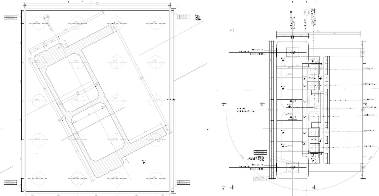
Figura 3: Pianta fondazioni (a sinistra) e pianta pulvino (a destra)
