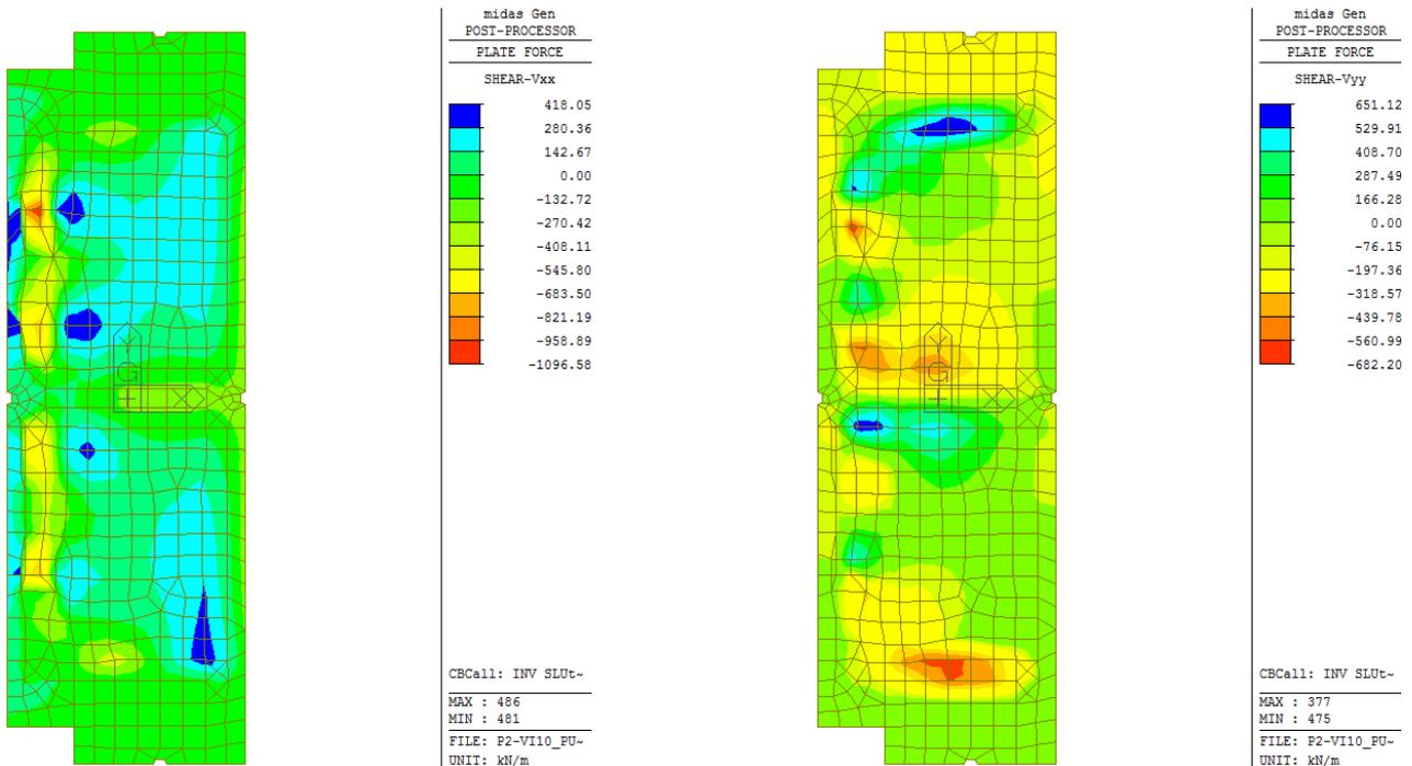
Figura 28: Taglio longitudinale (a sinistra) e trasversale (a destra) - Involuppo delle combinazioni SLU statiche/sismiche
