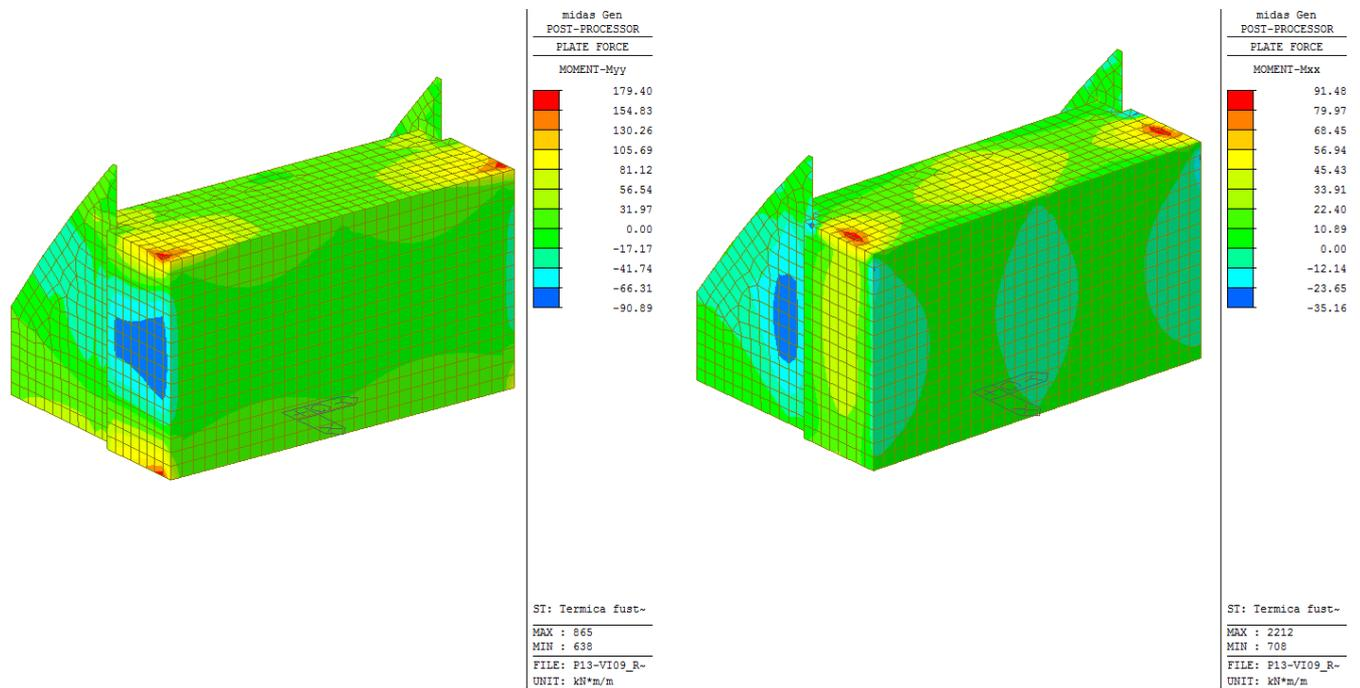
Figura 41: Momento flettente nel piano orizzontale (a destra) e nel piano verticale (a sinistra) indotta dalla variazione termica fusto pila/fondazione
