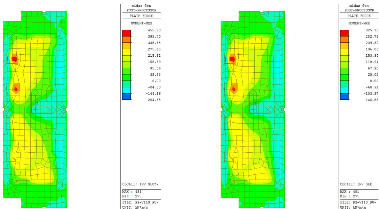
Figura 26: Momento flettente longitudinale - Inviluppo delle combinazioni SLU statiche/sismiche (a sinistra) e SLE (a destra)
