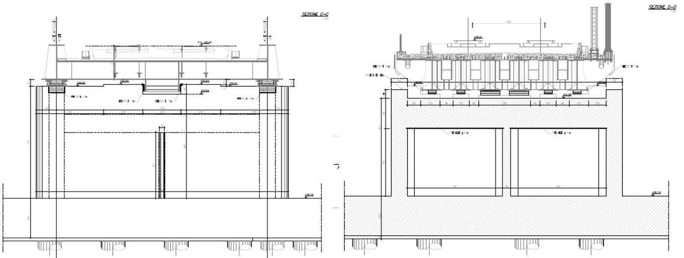
Figura 2: Sezione trasversale lato impalcato L=78m (a sinistra) e lato impalcato metallico L=40m (a destra)
