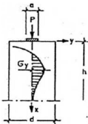
Figura 21: Curva delle tensioni di trazione trasversale  $\sigma_y$
