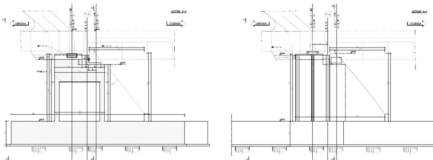
Figura 1: Sezione (a sinistra) e prospetto (a destra) longitudinali rispetto all'asse del viadotto
