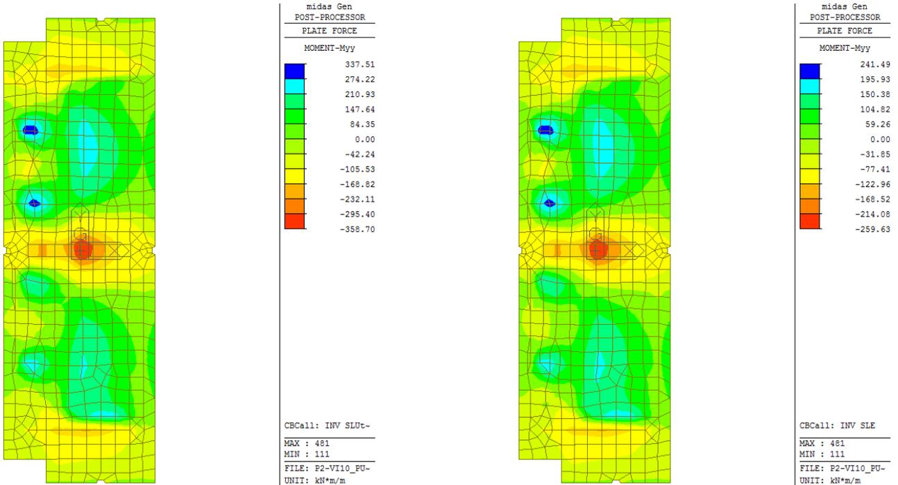
Figura 27: Momento flettente trasversale - Involuppo delle combinazioni SLU statiche/sismiche (a sinistra) e SLE (a destra)
