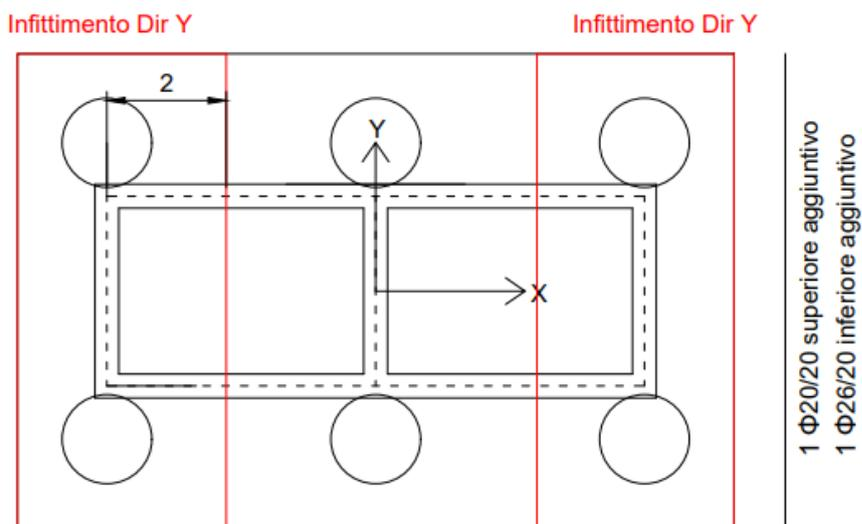
Figura 37 – Zone di infittimento dell'armatura a flessione del plinto
