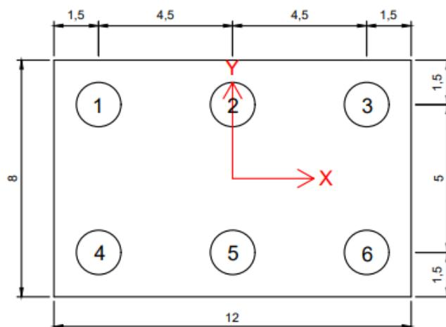
Figura 23 – Geometria del plinto di fondazione
