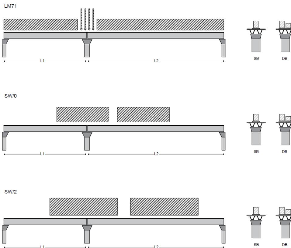
Figura 4- Posizione treni di carico - massimo sforzo assiale
