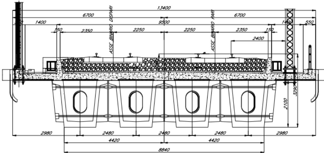
Figura 2 - Sezione impalcato c.a.p.
