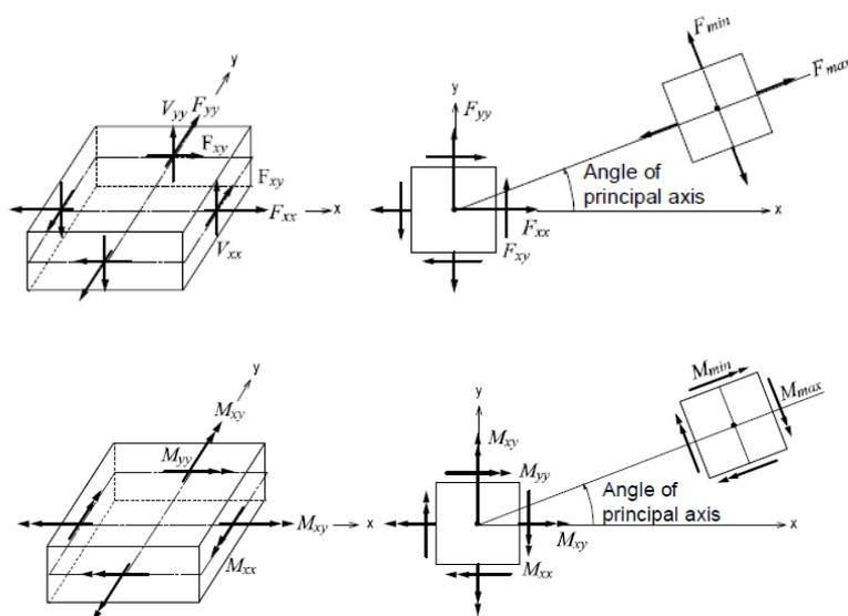
Figura 29 – Posizioni di output delle forze dell'elemento piastra per unità di lunghezza e convenzione del segno
