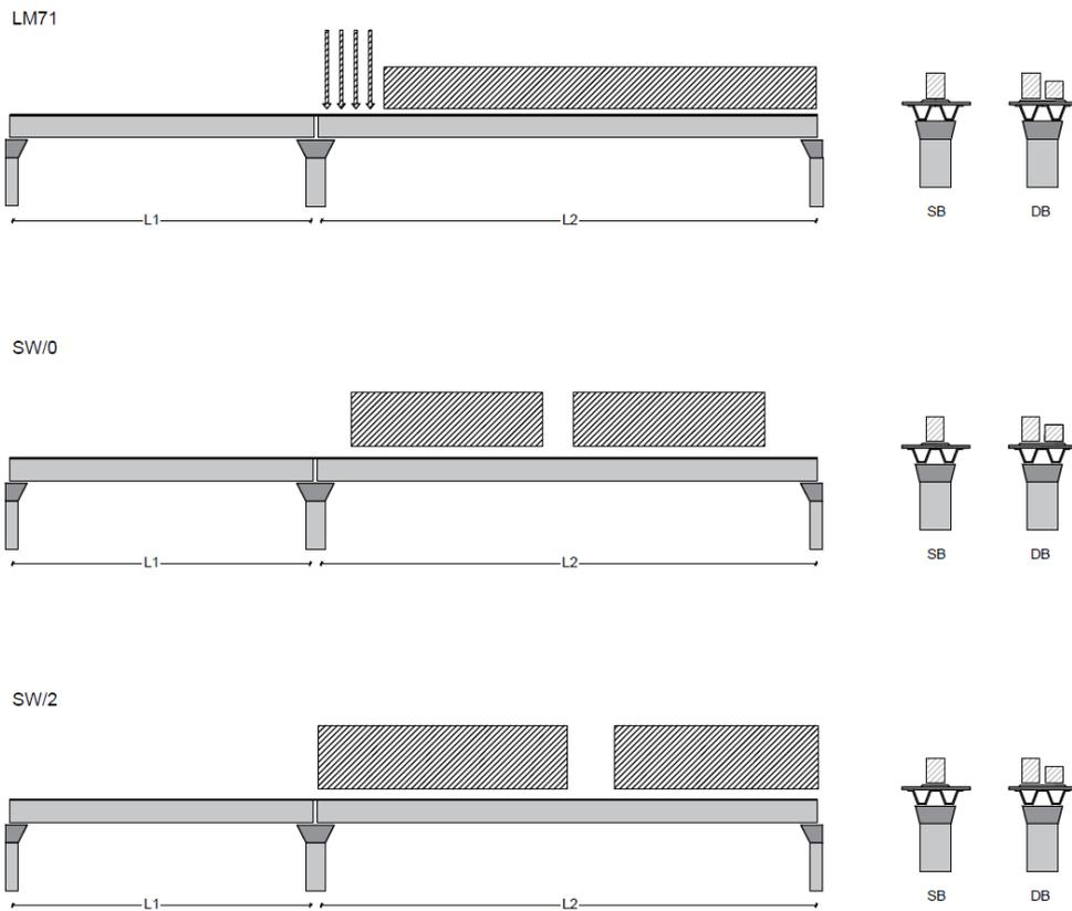
Figura 5- Posizione treni di carico – massimo momento longitudinale
