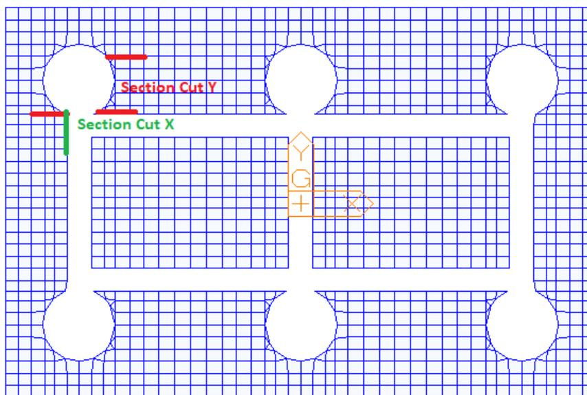
Figura 39 – Section cut considerate per la verifica a taglio
