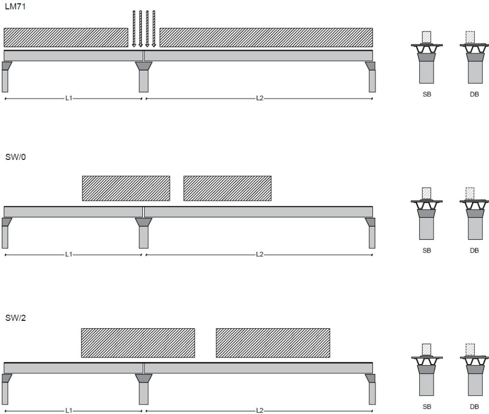
Figura 6- Posizione treni di carico – massimo momento trasversale
