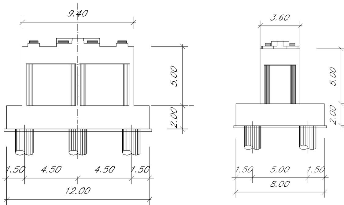
Figura 3 - Pianta e sezioni pila
