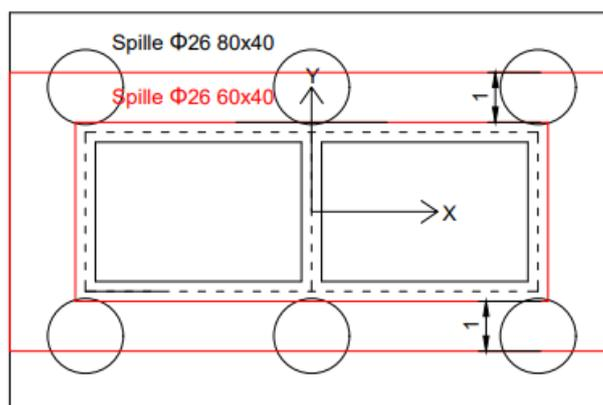
Figura 38 – Armatura a taglio del plinto
