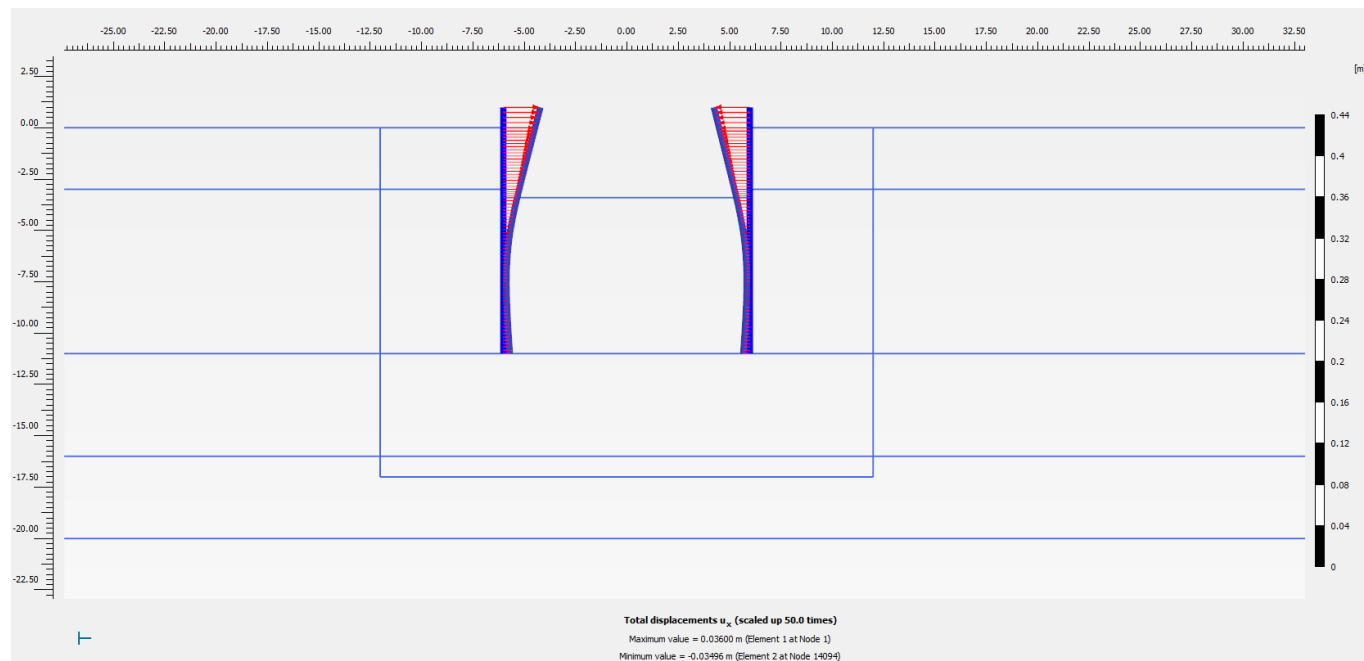
Figura 25 - Sezione 2, Spostamenti totali palancole SLE
