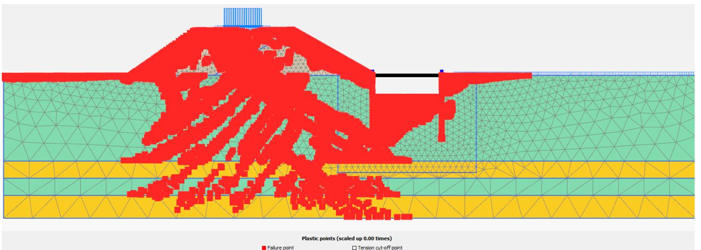
Figura 34 - Sezione 2, Punti di plasticizzazione al termine della verifica di stabilità globale
