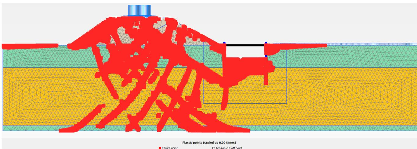
Figura 25 - Sezione 1, Punti di plasticizzazione al termine della verifica di stabilità globale
