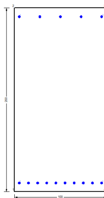
Figura 53 – Sezione implementata in RC-SEC
