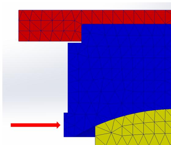
Come limite di accettabilità si verifica che la forza risultante data dalle pressioni agenti sul calcestruzzo sia inferiore della capacità resistente del calcestruzzo definita con formulazione in accordo all'Eurocodice UNI EN 1992-1-1 §6.7:
