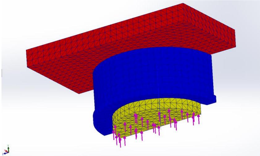
Il carico orizzontale viene applicato al modello come una pressione normale con distribuzione parabolica sull'area di contatto tra pistone e anello elastico (la rappresentazione sottostante ha come unico scopo quello di riportare la porzione di pistone caricata, la distribuzione del carico, come descritto in precedenza, è parabolico e non uniforme):
