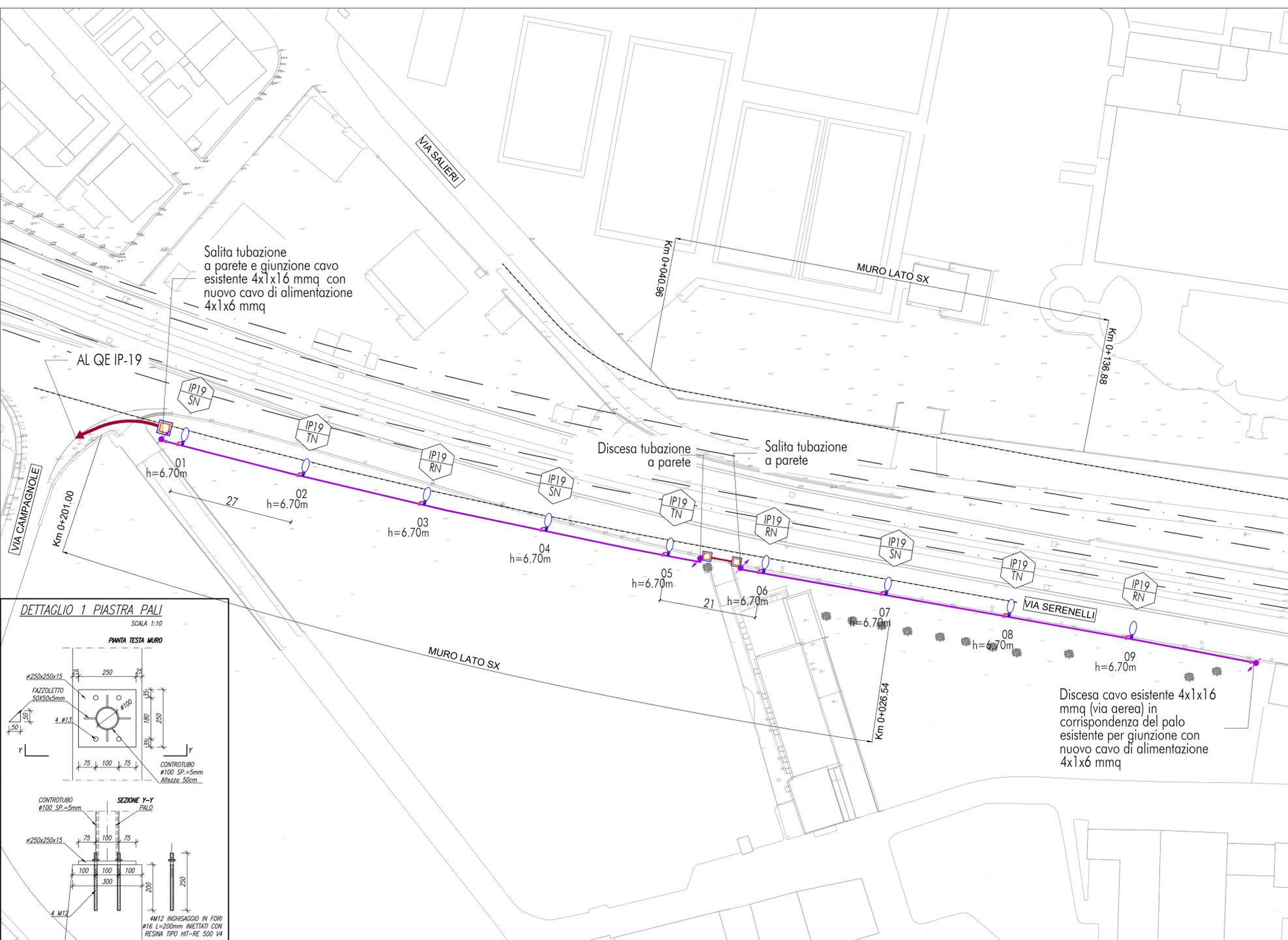
DETTAGLIO TIPOLOGICO PALO DI ILLUMINAZIONE STAFFATO TESTA MURO
