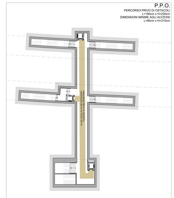
PIANTA SOTTOPASSO, scala 1:200
