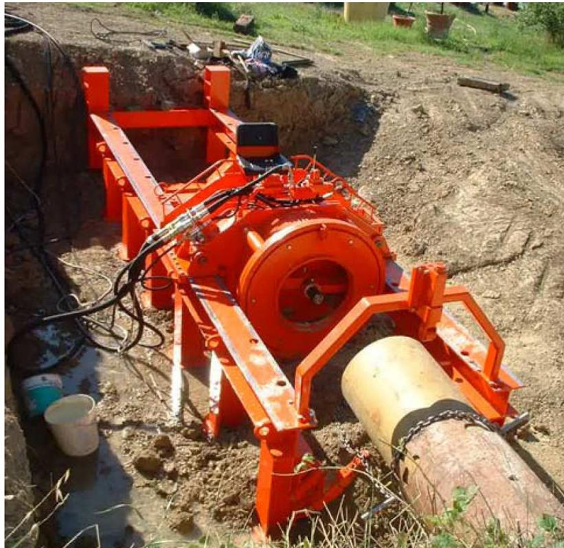
**Figura 3.7: Esempio di Trivella Spingitubo**
