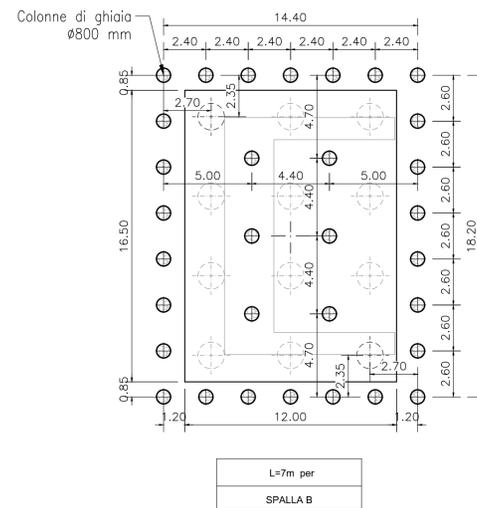
NOTA: Il diametro della colonna si intende il diametro finito, ricavabile dalla quantità di materiale introdotto.
