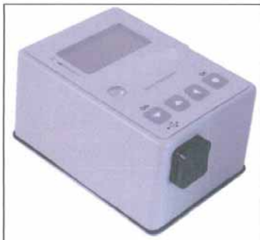
Tromografo digitale triassiale TROMINO
