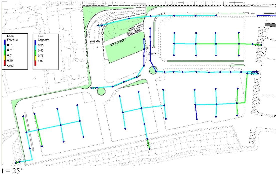
**Figura 53: risultati del modello di calcolo per  $T_r = 20$  anni, a 10, 15, 20 e 25 minuti dall'inizio della precipitazione – Zona portuale Sud**
