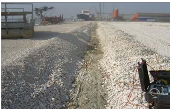
Figura 72 – (a) Stendimento di sismica a rifrazione e microtremors. (b) Fori cross-hole.
