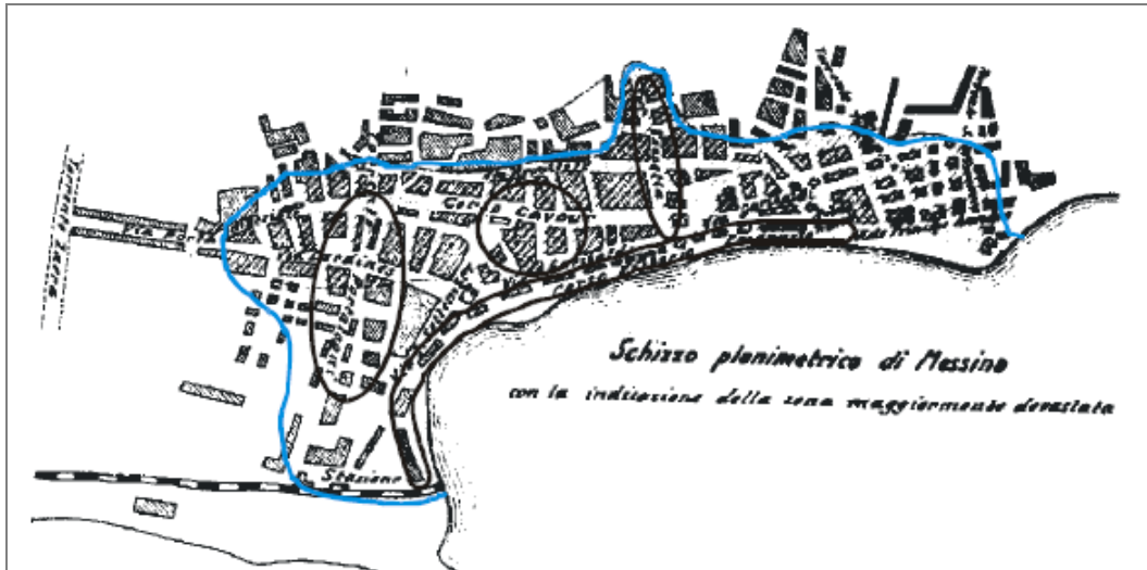
Figura 10 – Immagine riassuntiva tratta da Baratta (1910) e modificata. L'area all'interno della linea grigia è quella dove sono stati osservati i danni maggiori nel 1783 e 1908. Le area all'interno delle linee nere sono state evidenziate dall'analisi degli eventi minori (terremoti del 1693, 1894 e 1905) e mostrano un ulteriore incremento di danno
