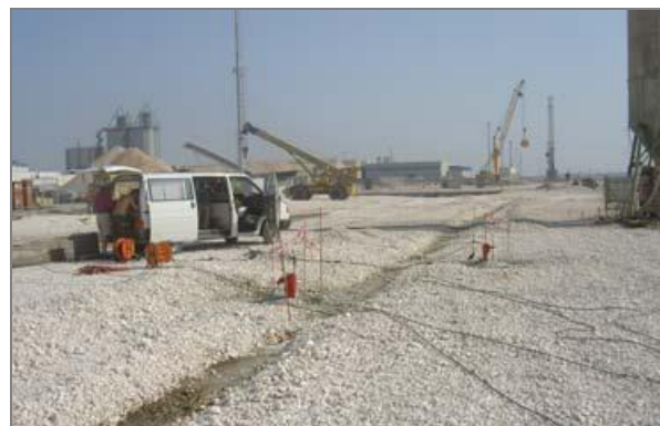
Figura 72 – (a) Stendimento di sismica a rifrazione e microtremors. (b) Fori cross-hole.
