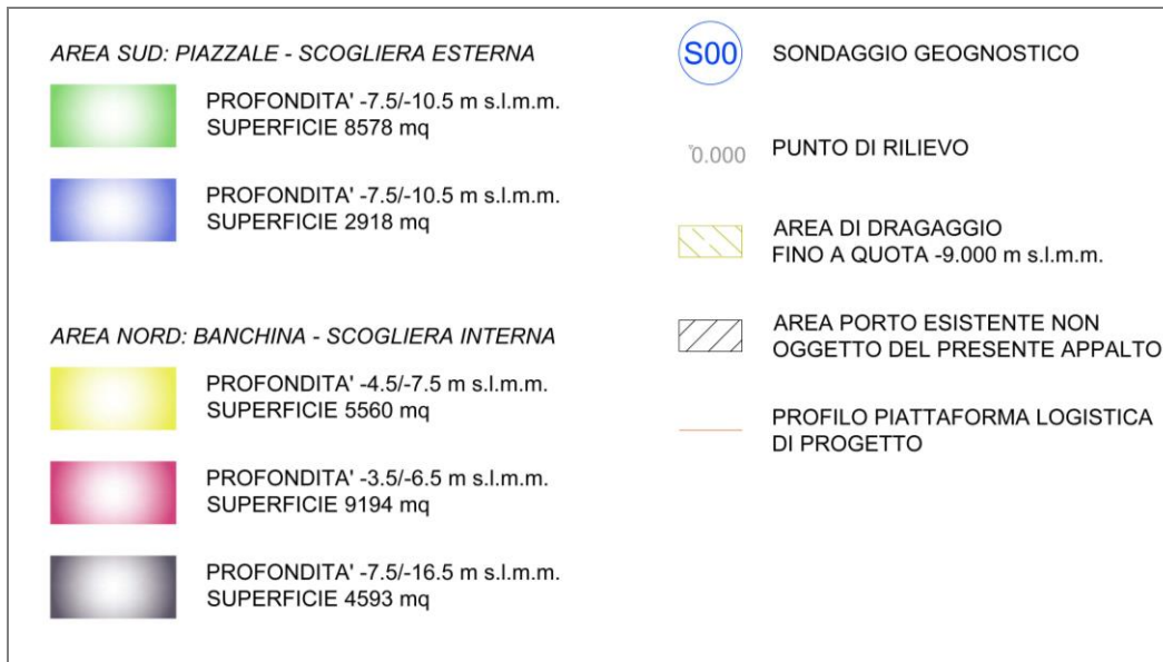
Figura 65 – Planimetria interventi di vibroflottazione - legenda.
