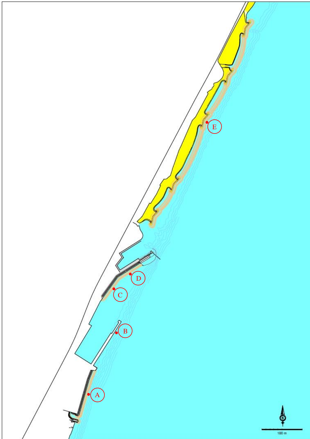
Figura 7.1 – Ubicazione dei punti significativi per la scelta delle quote di progetto.
