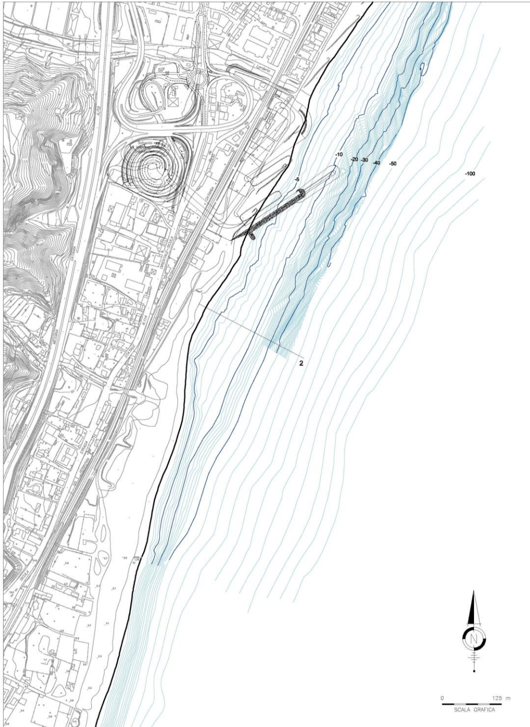
Fig. 7.1 – Tremestieri: ubicazione del profilo trasversale utilizzato per il calcolo del trasporto longitudinale (batimetria indicativa precedente alla costruzione degli approdi esistenti)
