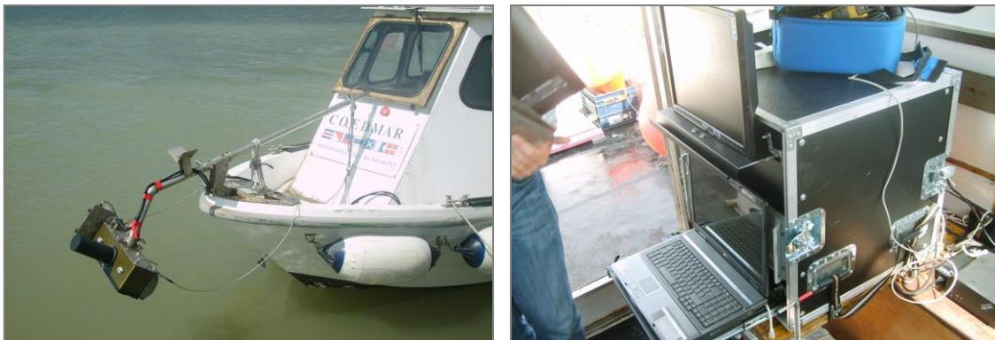
**Figura 8 – Strumentazione Multibeam**
