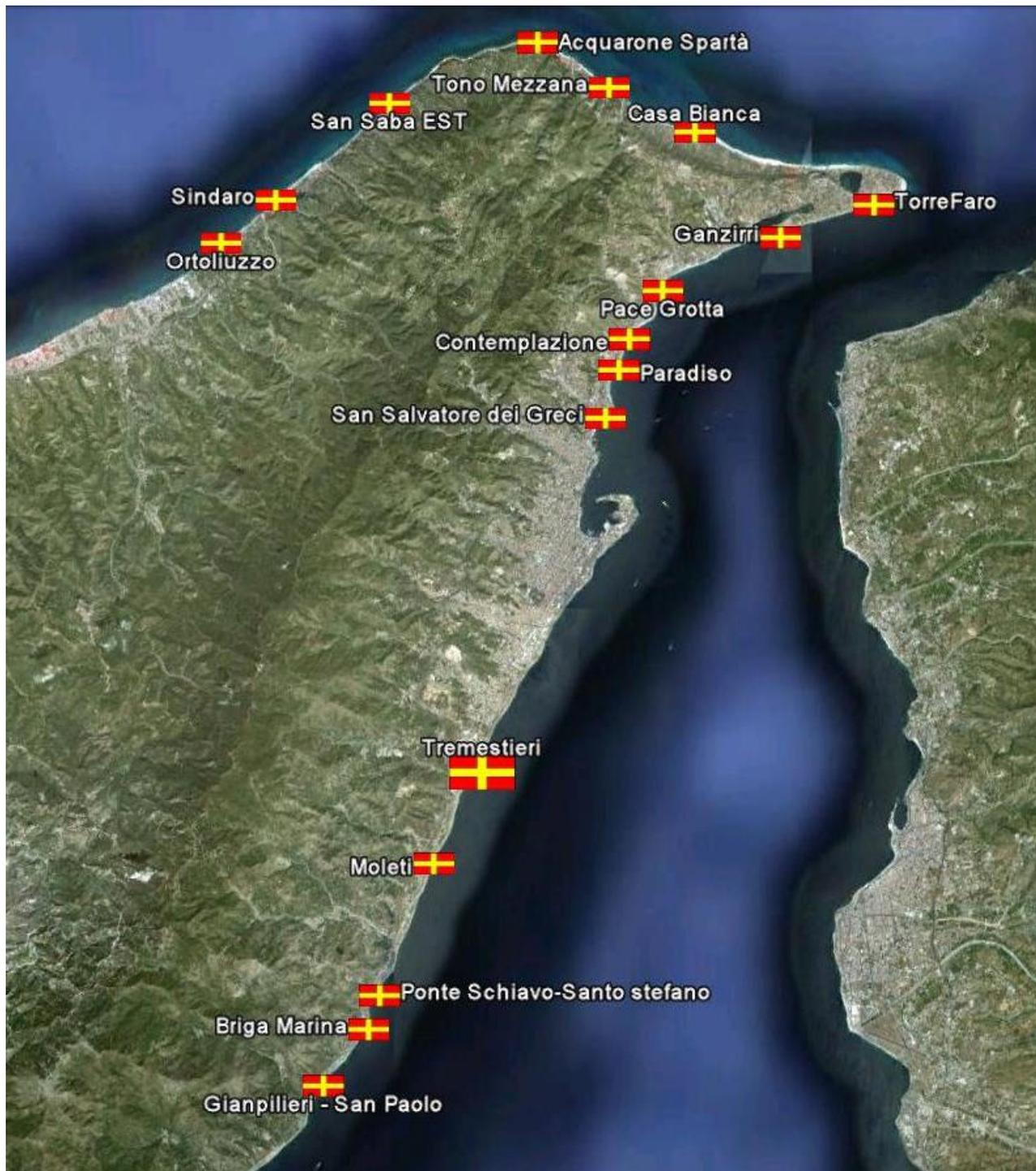
**Figura 4 – Localizzazione dei siti presi in esame per il rifornimento degli arenili con i sedimenti provenienti dal dragaggio**
