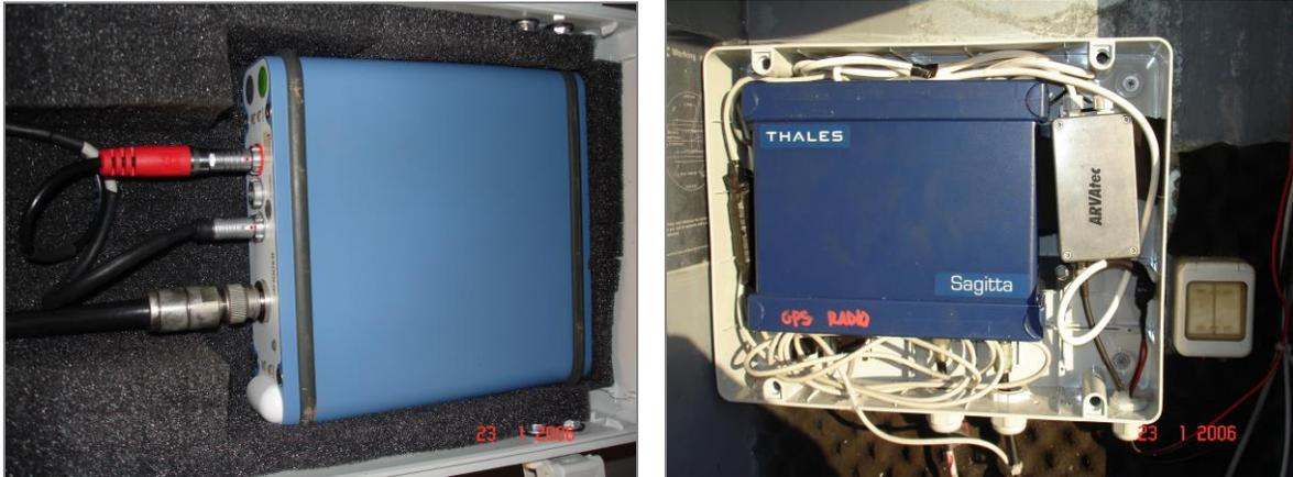
**Figura 5 – Strumentazione GPS-RTK acquisizione dati**
