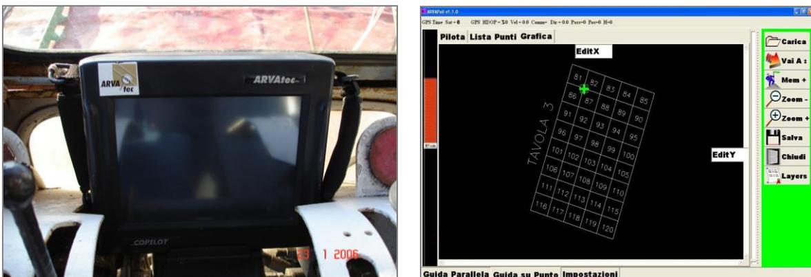
**Figura 6 – Strumentazione video GPS-RTK per controllo posizionamento benna**
