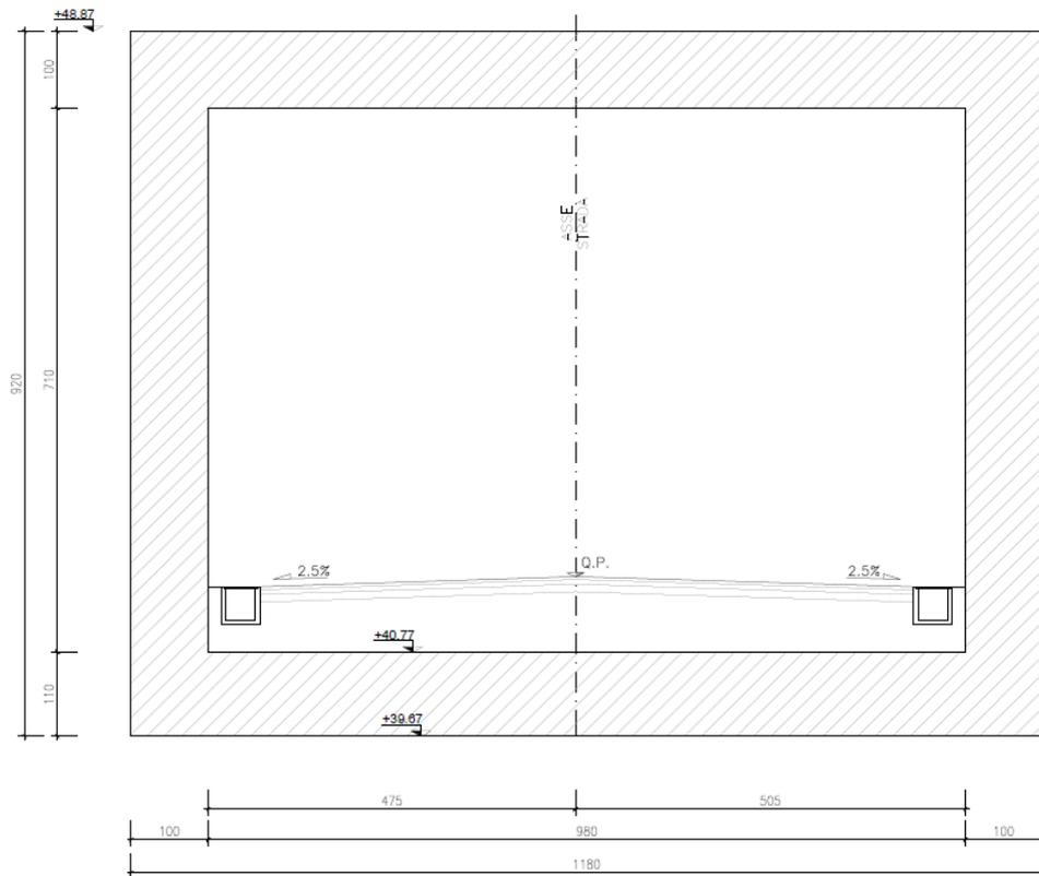
**Figura 2: Sezione trasversale linea storica**
