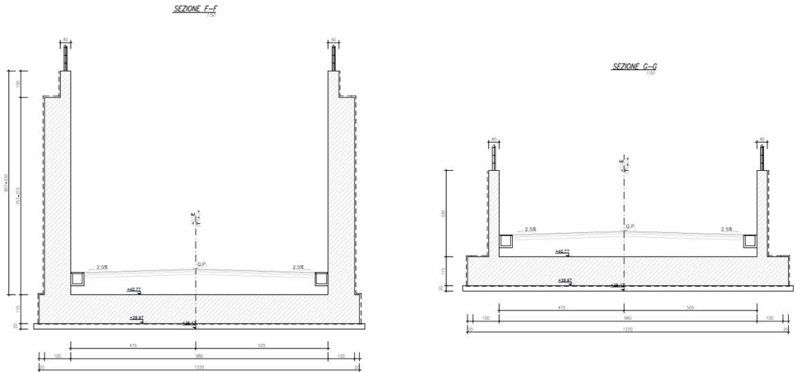
**Figura 4: Sezione trasversale muri lato NORD**
