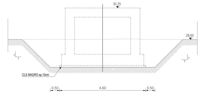
SEZIONE MURO TIPO
