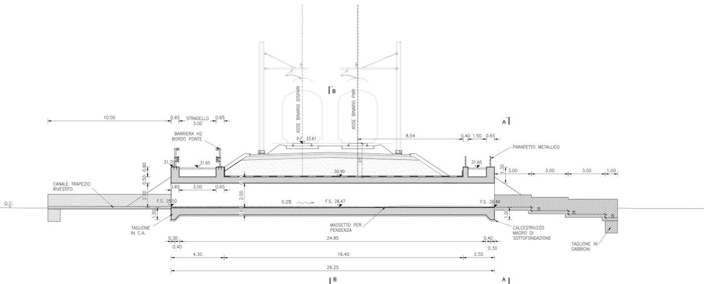
SEZIONE TIPO MURO TIPO "A2"
