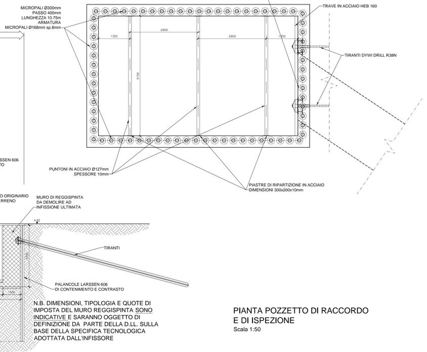
**PIANTA POZZETTO DI RACCORDO E DI ISPEZIONE**
