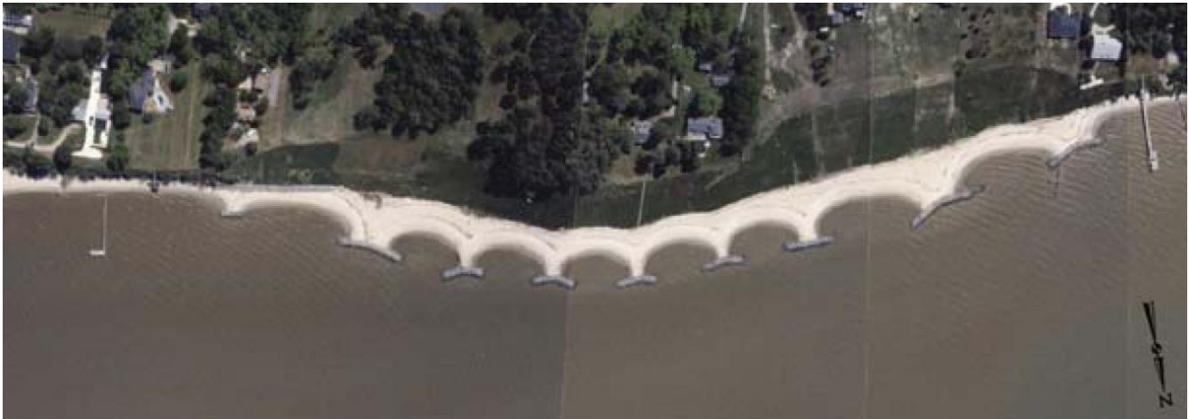
Figura 7 – Esempio di protezione di un litorale con scogliere parallele
