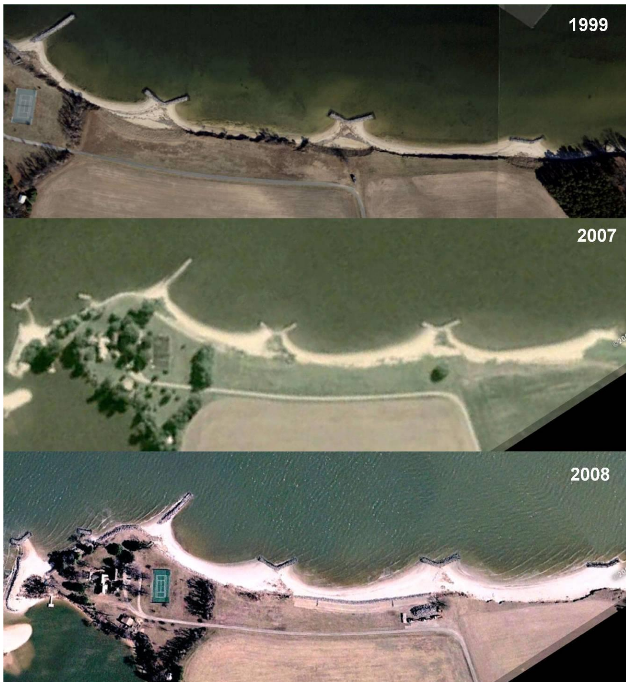
Figura 8 – Esempio dell’evoluzione di un litorale protetto da scogliere simili a quelle in progetto
