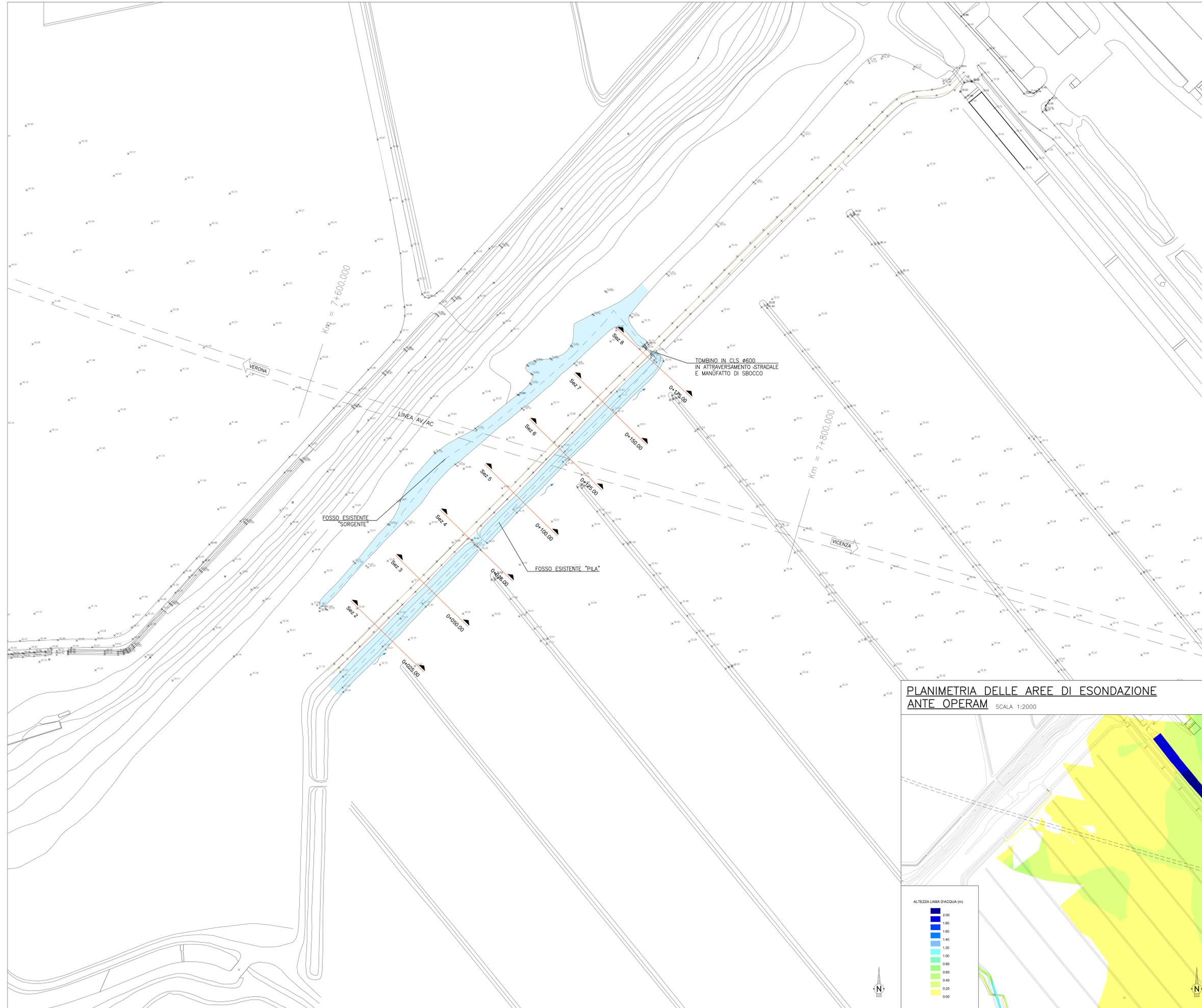
PLANIMETRIA DELLE AREE DI ESONDAZIONE ANTE OPERAM SCALA 1:2000
