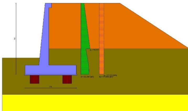
Fig. 31 - Diagramma delle pressioni (combinazione sismica) (Combinazione n° 7)
